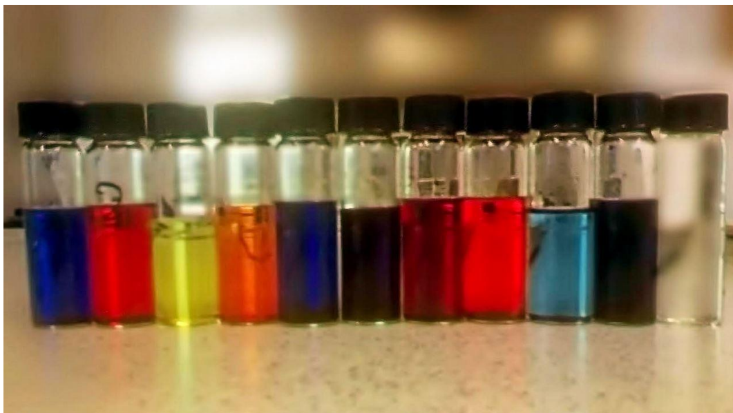
Slika 5. Prikaz otopina Brooker merocijanina (1-metil-4-([oksocikloheksadieniliden]etiliden)-1,4-dihidropiridin, MOED) otopljenog slijeva na desno u acetonu, 96% etanolu, octenoj kiselini, vodi, DMF-u, acetonitrilu, propan-2-olu, metanolu, THF-u te DMSO-u. Krajnje desno je čista voda za usporedbu. 22
