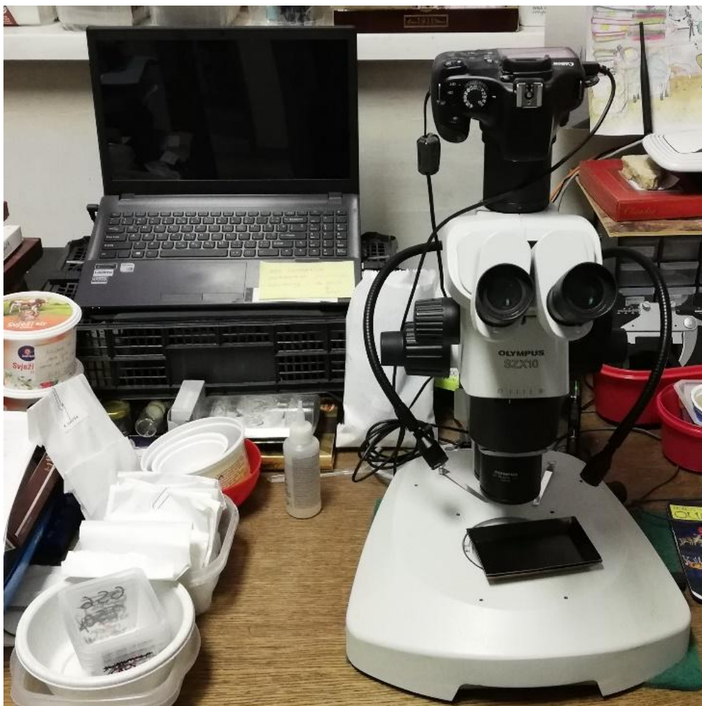
Slika 7: Stereo-mikroskop Olympus - SZX10 korišten pri proučavanju mikroorganizama i fotoaparat Canon EOS 1100D
