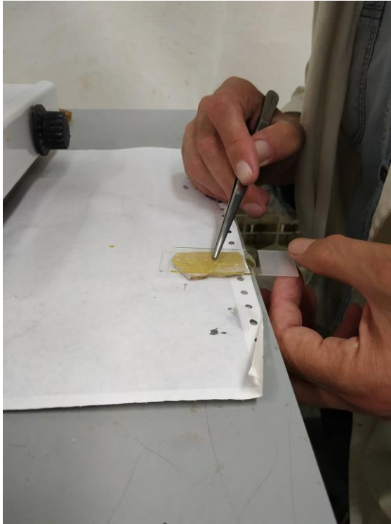
Slika 10. Lijepljenje polirane pločice na predmetno stakalce (vlastita fotografija).
