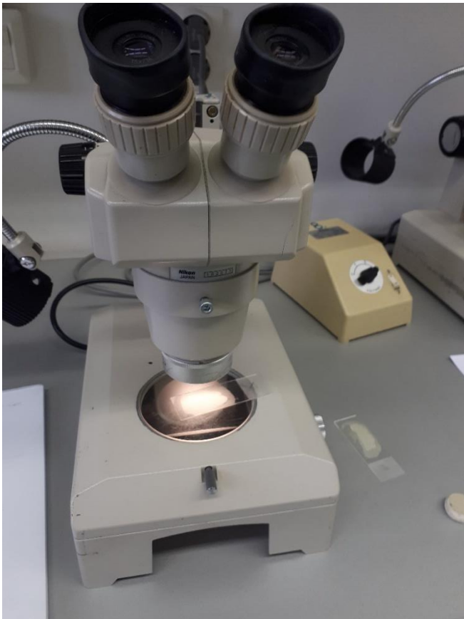
Slika 14. Analiza mikroskopskog preparata na stereoskopskoj lupi (NIKON) (vlastita fotografija).
