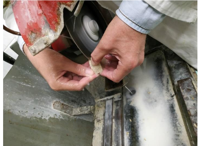
Slika 7. Oblikovanje pločica na dijamantnoj pili (vlastita fotografija).
