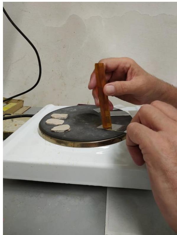
Slika 9. Nanošenje „Kanada balzama“ na predmetno stakalce (vlastita fotografija).
