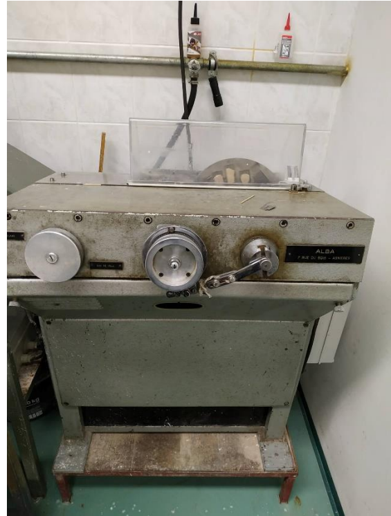
Slika 11. Strojno poliranje na uređaju „Gramofon“ (ALBA) (vlastita fotografija).
