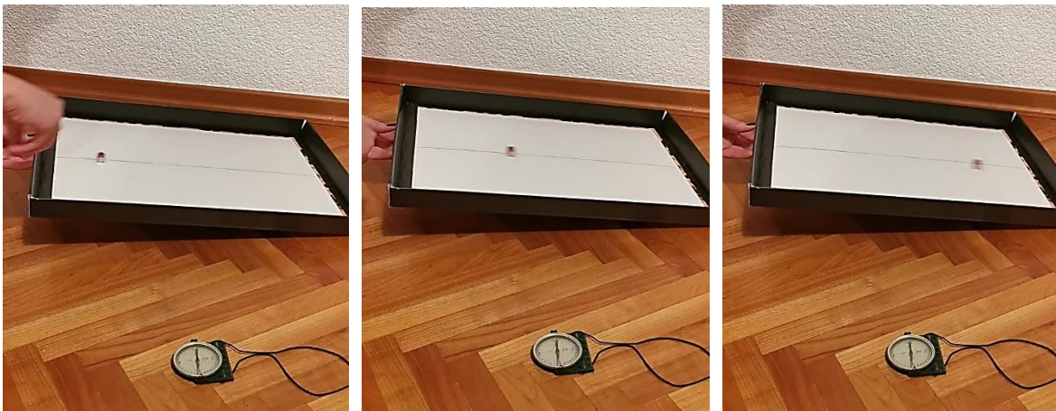
Slika 57 Puštanje magneta niz kosinu koja je u smjeru istok-zapad
