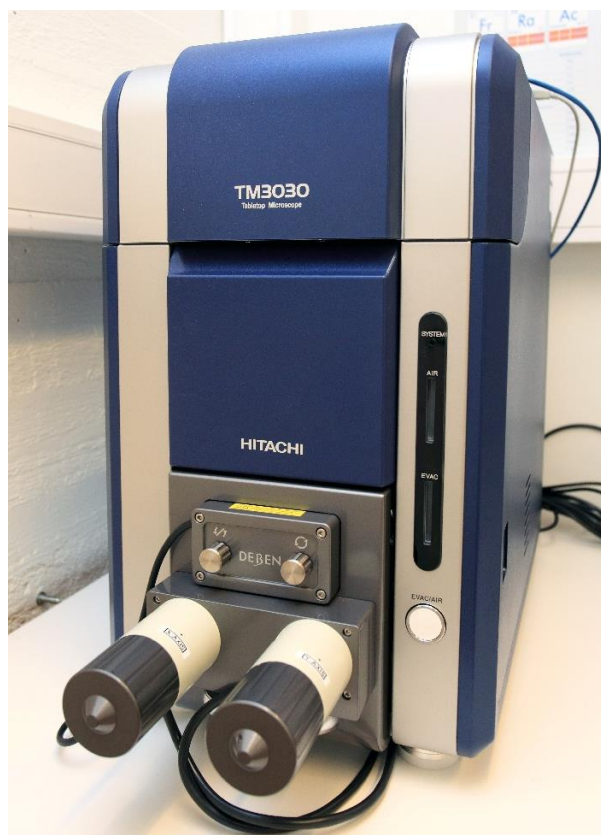
Slika 10. Skenirajući elektronski mikroskop (HITACHI TM3030 Tabletop Microscope) korišten tijekom izrade rada
