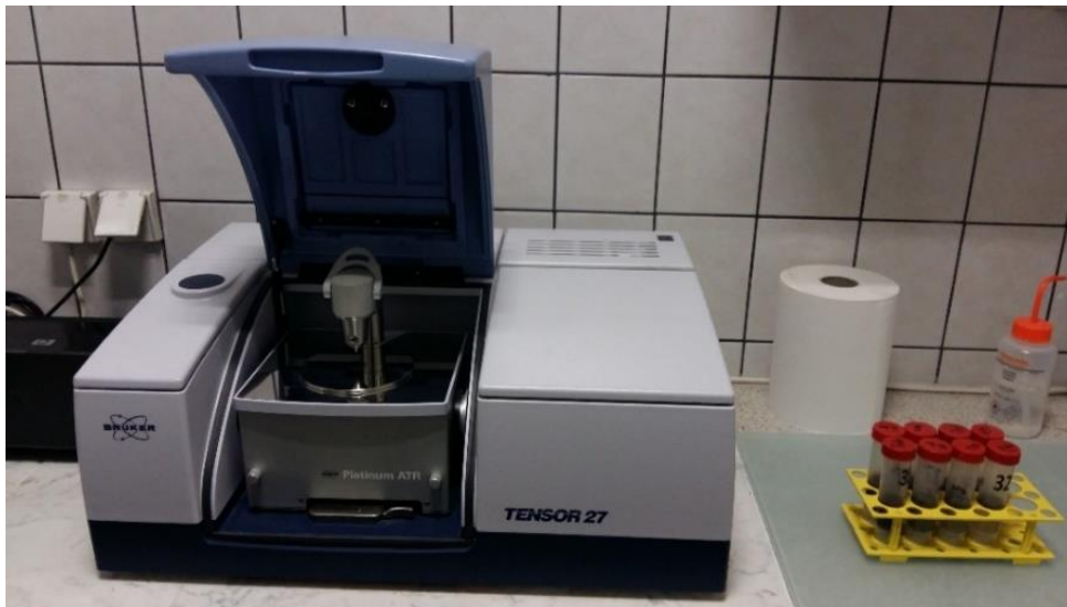
Slika 18. Tensor 27 spektrometar za snimanje FTIR spektara. Slikano na mineraloško-petrografskom zavodu Geološkog odsjeka PMF-a.
