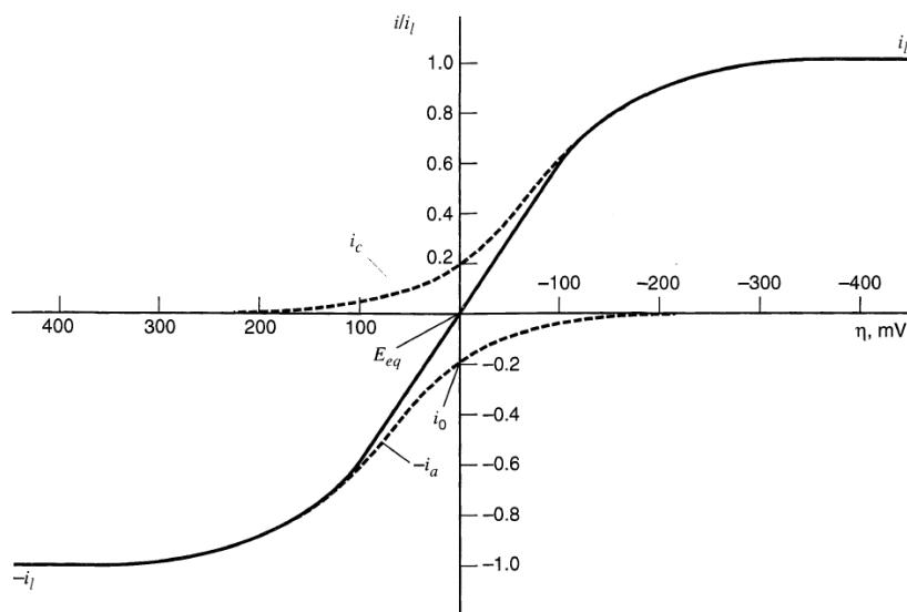
Slika 6:  $i_0\text{-}\eta$  krivulje za sustav dan jednadžbom (2.14) uz  $n = 1$ .  $\alpha = 0,5$ ,  $T = 298K$ ,  $i_0/i_l = 0,2$ .<sup>2</sup>
