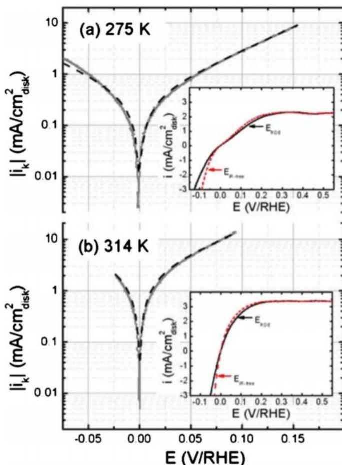
Slika 7: Struje izmjene za oksidaciju i dobivanje vodika na polikristalnoj platinskoj elektrodi ( $c(\text{KOH}) = 0,1 \text{ mol/dm}^3$ ) (puna siva linija) te njihovo slaganje s Butler-Volmerovom jednadžbom (iscrtkana crna crta). Korekcije za nekompenzirani otpor elektrolita je primijenjen na polarizacijske krivulje, što je prikazano u na grafovima desno. Crvena linija predstavlja polarizacijske krivulje prije, a crna nakon korekcije.<sup>13</sup>
