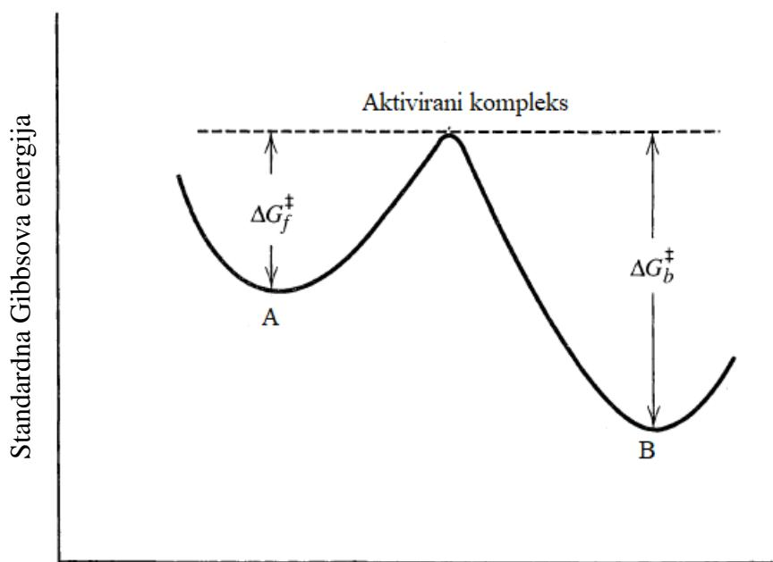
Slika 2: Standardne Gibssove energije aktivacije tvari A i B u monomolekularnoj reakciji.<sup>2</sup>
