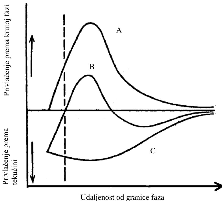
Slika 3: Ovisnost privlačnih sila krute i tekuće faze na česticu blizu granice faza o udaljenosti. Slovom A je označena krivulja ovisnosti privlačne sile krute faze na česticu, slovom C krivulja privlačne sile tekućine, a slovom B rezultanta te dvije sile<sup>4</sup>.
