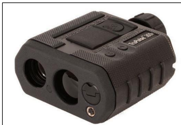
Sl. 49. Laserski daljinomjer TruPulse 360°R
