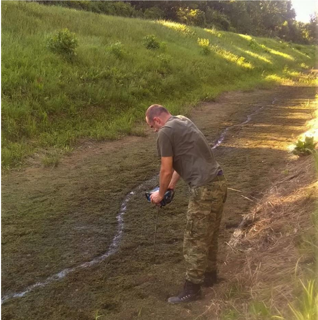
Sl. 51. Mjerenje nosivosti dna vodotoka na lokaciji "V"
