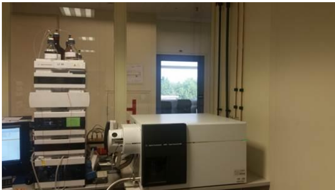
Slika 11. Vezani sustav tekućinski kromatograf ultravisoke djelotvornosti–spektrometar masa s trostrukim kvadropolom, Agilent 6490
