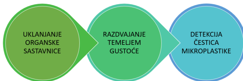
Slika 8. Shematski prikaz glavnih koraka u izolaciji čestica mikroplastike. Shema: M. Puđak
