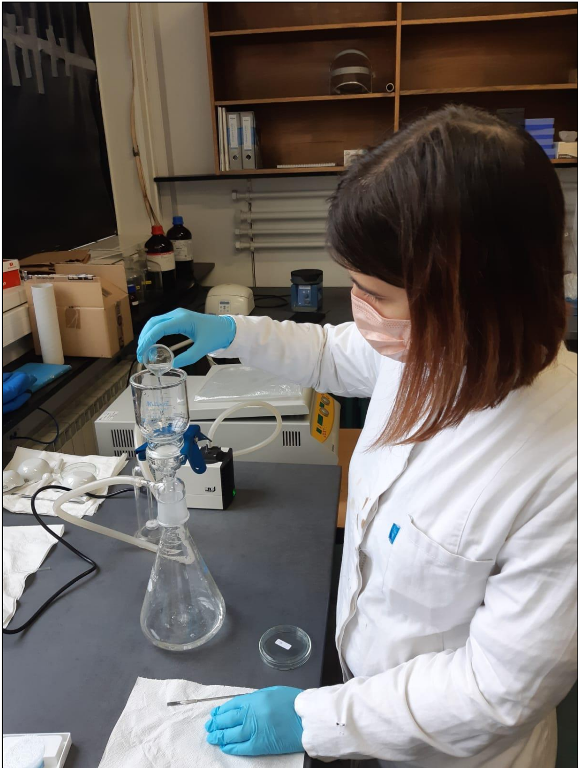
Slika 13. Vakuumska filtracija uzoraka mikroplastike i otopine NaBr ( \rho=1,266 g/mL). Foto: I. Grgić
