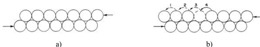
Slika 9. Prikaz modela mehaničkog smicanja slojeva kristala metala: a) dva sloja podvrgnuta mehaničkoj sili, b) uzastopno klizanje atoma tijekom smicanja (preuzeto iz literaturnog izvora 23 )
