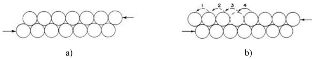
Slika 9. Prikaz modela mehaničkog smicanja slojeva kristala metala: a) dva sloja podvrgnuti mehaničkoj sili, b) uzastopno klizanje atoma tijekom smicanja (preuzeto iz literaturnog izvora<sup>23</sup>)
