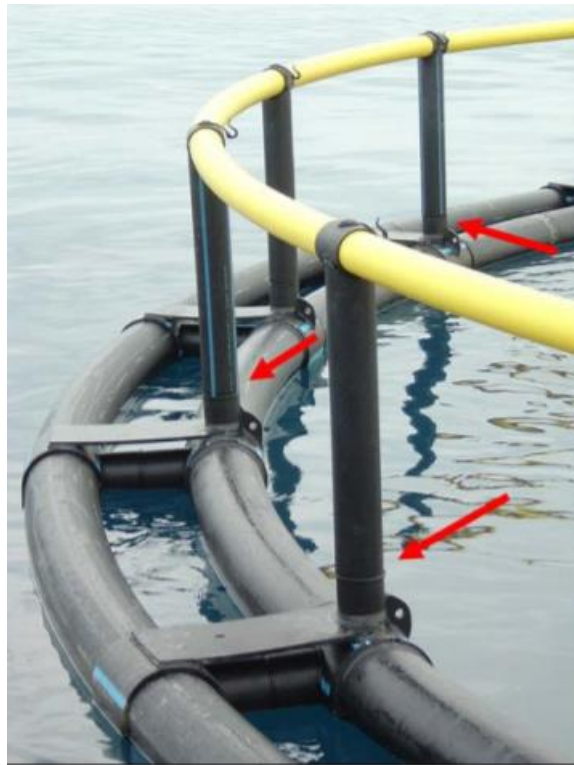
Slika 2 HDPE cijevi koje čine konstrukciju plutajućih kaveza [4]
