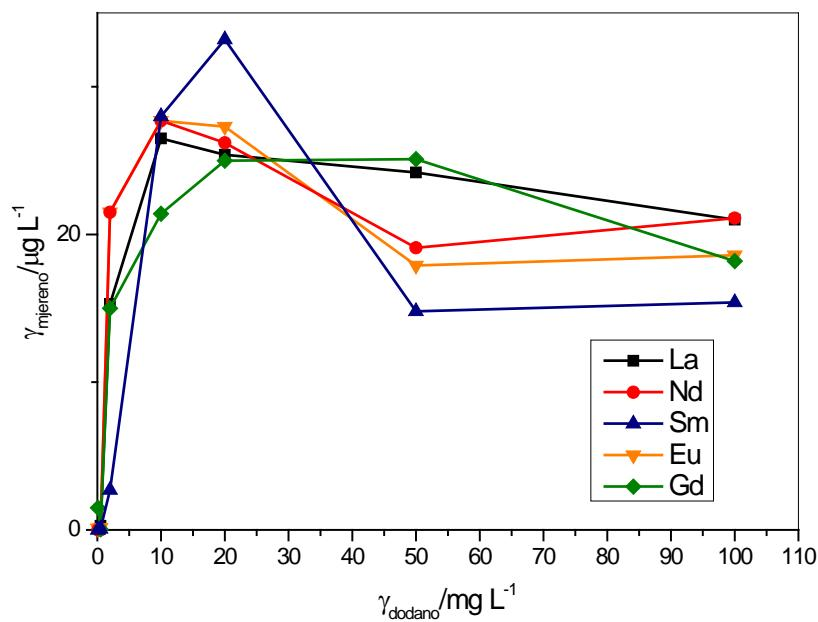
Slika 15. Koncentracija elemenata nakon sorpcije na nanočesticama nZVI mjerena metodom ICP-MS
