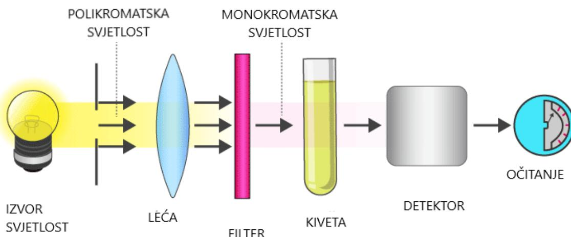
Slika M3. Shematski prikaz jedne od mogućih tehničkih izvedbi kolorimetra
