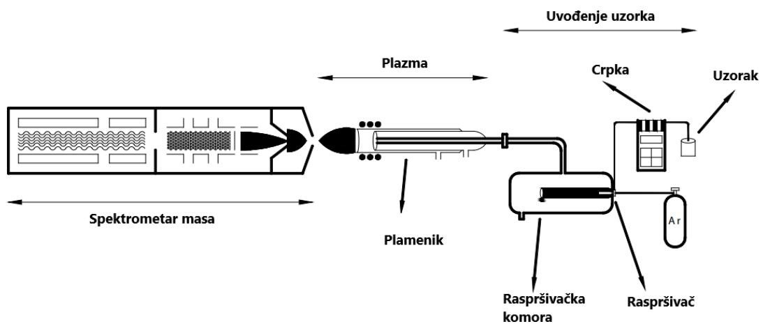
Slika 6. Shematski prikaz spektrometra masa uz induktivno spregnutu plazmu (preuzeto i prilagođeno prema<sup>39</sup>)
