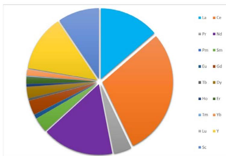
Slika 1. Prosječna koncentracija pojedinih metala rijetkih zemalja u zemljinoj kori u odnosu na ukupnu prosječnu koncentraciju svih metala rijetkih zemalja ( $233 \mu\text{g/g}$ )<sup>8</sup>
