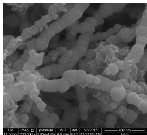
Slika 11. Neutralne nanočestice željeza snimljene metodom SEM<sup>4</sup>
