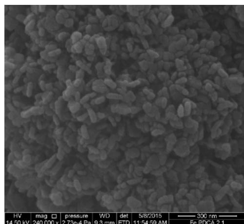
Slika 12. Nanočestice željeza modificirane sa PDCA u množinskom omjeru 2:1 snimljene metodom SEM<sup>40</sup>
