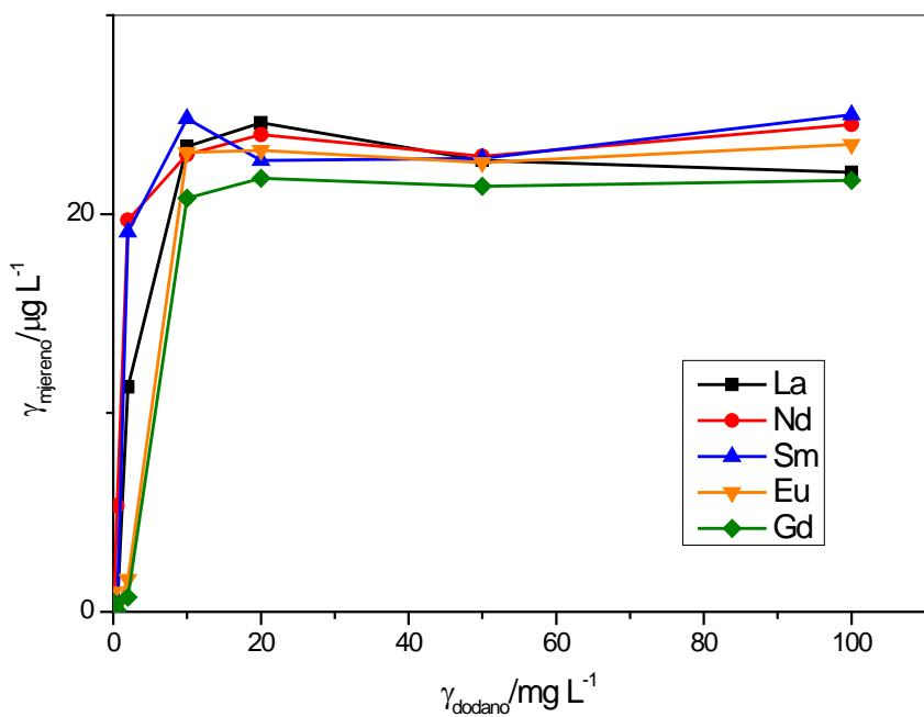
Slika 16. Koncentracija elemenata nakon sorpcije na nanočesticama nZVI-PDCA 2:1 mjerena metodom ICP-MS
