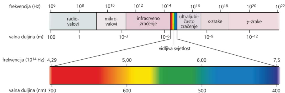
Slika M1. Spektar elektromagnetskog zračenja (preuzeto iz<sup>12</sup>)
