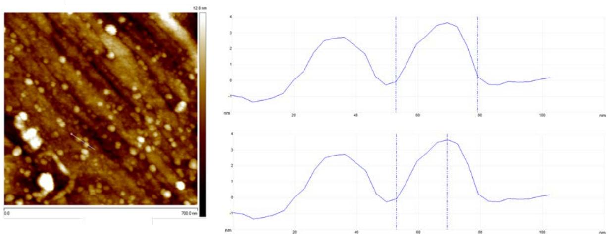
Slika 14. Nanočestice željeza modificirane s PDCA u molarnom omjeru 2:1 snimljene metodom AFM
