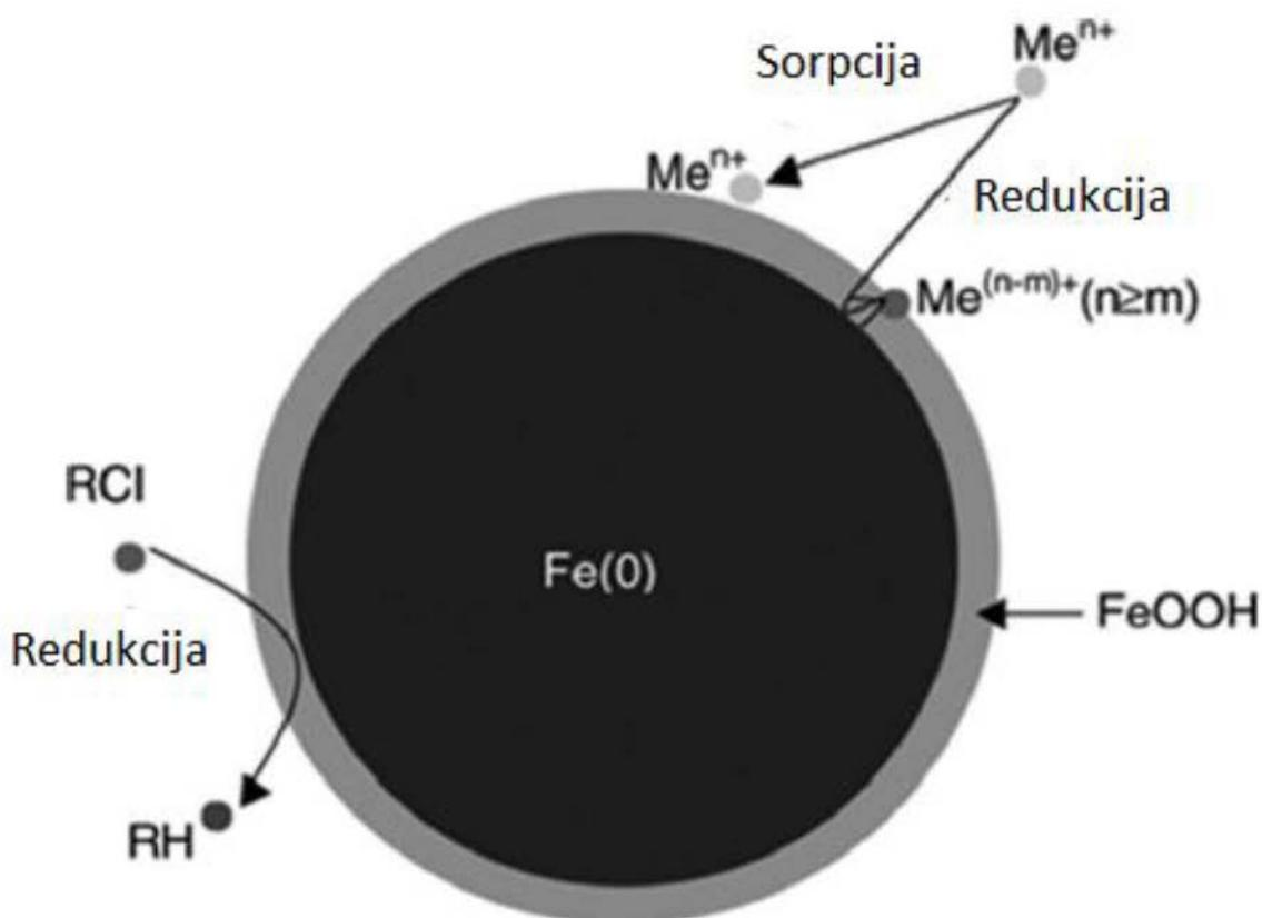
Slika 5. Shematski prikaz neutralne nanočestice željeza (preuzeto i prilagođeno prema<sup>30</sup>)
