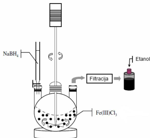
Slika 4. Aparatura za sintezu nanočestica željeza prema Zhang-u i Whang-u (preuzeto i prilagođeno prema<sup>30</sup>)
