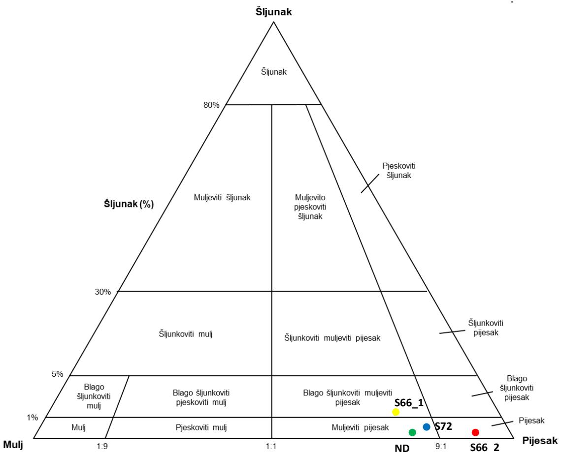
**Slika 6.** Granulometrijski sastav uzorka sedimenata koji su na površinu izašli likvefakcijom uslijed petrinjskog potresa (29.12.2020., M6,2) u trokomponentnom dijagramu šljunka, pijeska i mulja, prilagođeno iz Blott i Pye (2001) prema Folk (1954).
