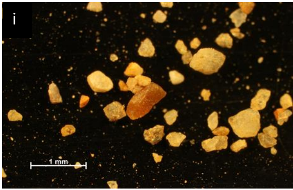
Slika 14. Fotografije zrna u uzorku S72 (i - zrno kvarca narančaste boje (nepotvrđeno), j - zrno tinjca u središtu okruženo kvarcom).
