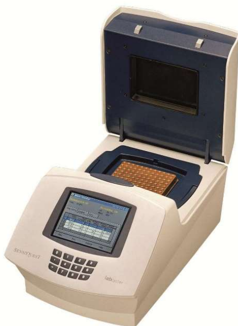
Slika 1 Uređaj u kojem se odvija lančana reakcija polimerazom ( https://www.sensoquest.de/what-is-a-thermocycler/?lang=en )
