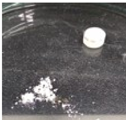
Slika 27. Bijeli prah \text{MoO}_3 nakon termogravimetrijske analize kompleksa [\text{MoO}_2(\text{L}^1)(\text{MeOH})] .
