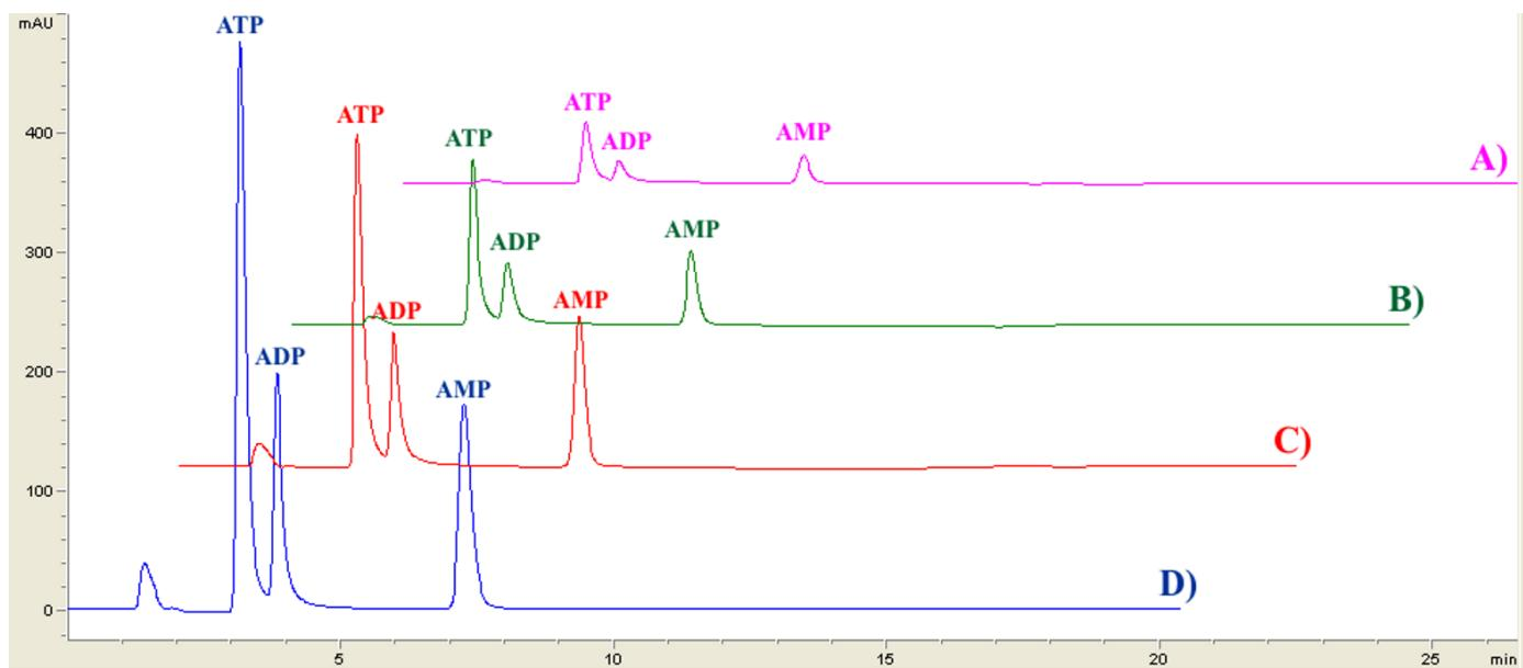
**Slika 18.** Preklopljeni kromatogrami otopina standarda koji su korišteni za konstruiranje baždarnog pravca (A-D) gdje su korištene koncentracije ATP od 40  $\mu\text{M}$  (A), 240  $\mu\text{M}$  (B), 600  $\mu\text{M}$  (C) i 1200  $\mu\text{M}$  (D) te koncentracije ADP i AMP od 20  $\mu\text{M}$  (A), 120  $\mu\text{M}$  (B), 300  $\mu\text{M}$  (C) i 600  $\mu\text{M}$  (D).
