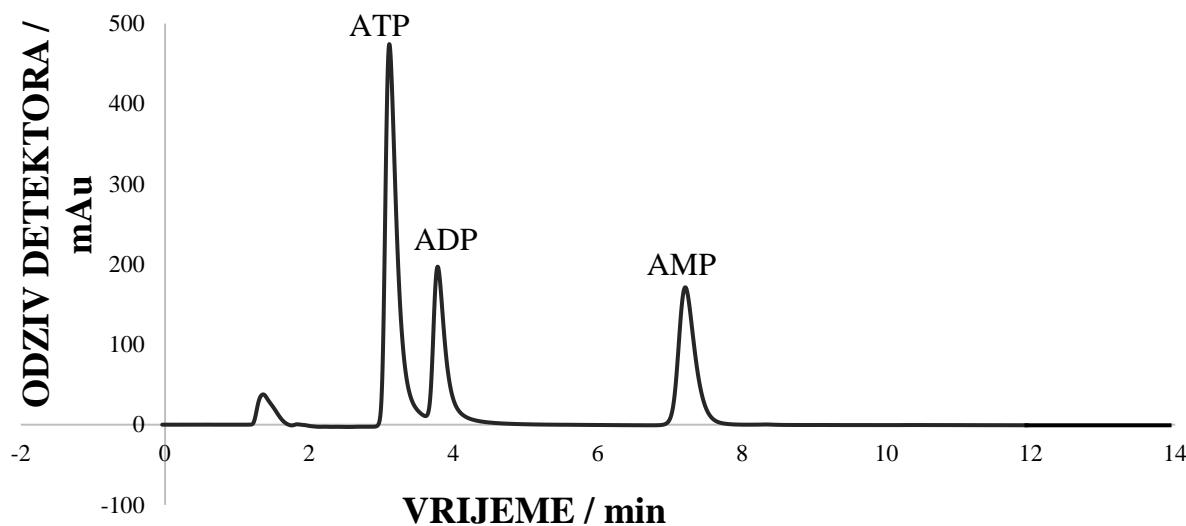
**Slika 13.** Uvećani kromatogram smjese standarda od 0 do 14 min, u kojem je koncentracija ATP  $1000 \mu\text{M}$ , a koncentracija ADP i AMP iznosi  $500 \mu\text{M}$ . Adenozin-fosfati razdvojeni su modificiranim metodom. Vrijeme zadržavanja molekule ATP iznosilo je 3,49 min, molekule ADP 4,17 min, a molekule AMP 7,78 min.
