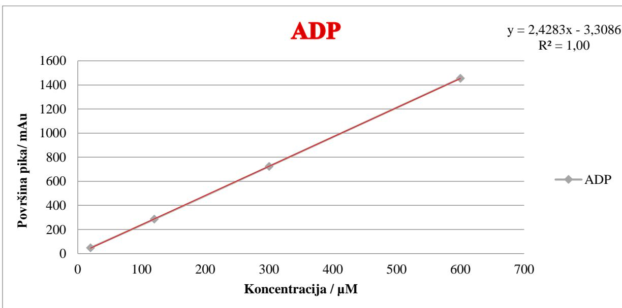
**Slika 16.** Baždarni pravac ovisnosti srednje vrijednosti površine pika o koncentraciji standardne otopine ADP u koncentraciji od 600, 300, 120 i 20  $\mu\text{M}$ . Svaka od navedenih koncentracija je analizirana u triplikatu s izračunatim % RSD  $\leq 1$ .
