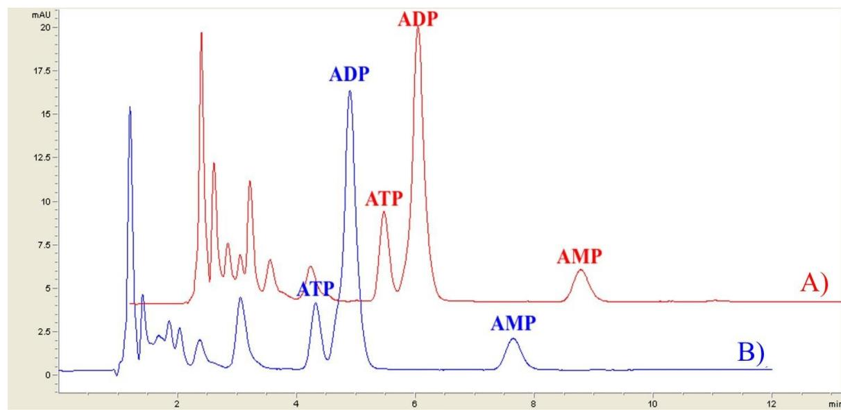
**Slika 19.** Preklopljeni kromatogrami ekstrahiranih adenozin-fosfata iz 500 µL (A) i 50 µL krvi (B).
