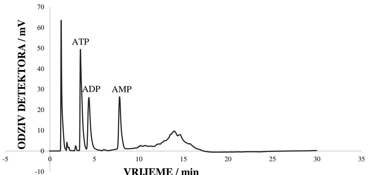
**Slika 22.** Kromatogram uzorka ljudske kapilarne krvi kojemu je dodana poznata koncentracija standardnog dodatka ( $200 \mu\text{M}$ ) prije pročišćavanja metodom  $\mu$ -SPE. Na kromatogramu su označeni pikovi ATP, ADP i AMP.
