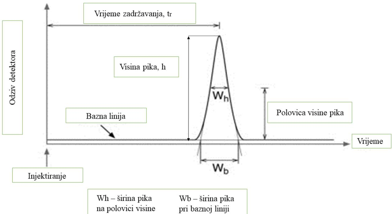
**Slika 11.** Shematski prikaz kromatograma s opisanim parametrima koji opisuju kromatografogram te tipični kromatografski pik.
