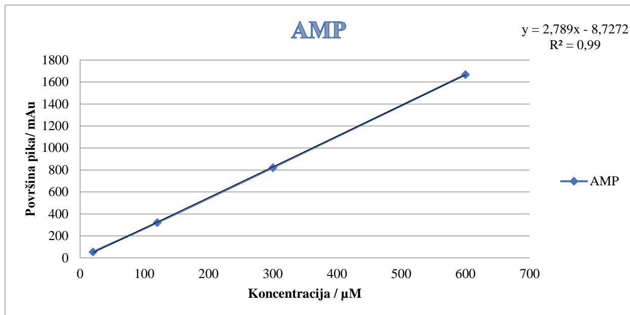
**Slika 17.** Baždarni pravac ovisnosti srednje vrijednosti površine pika o koncentraciji standardne otopine AMP u koncentraciji od 600, 300, 120 i 10  $\mu\text{M}$ . Svaka od navedenih koncentracija je analizirana u triplikatu s izračunatim % RSD  $\leq 1$ .
