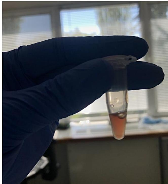
**Slika 20.** Zamućena crvena otopina ekstrahiranih adenozin-fosfata iz kapilarne ljudske krvi prije pročišćavanja primjenom filtera Microcon-10 kDa.
