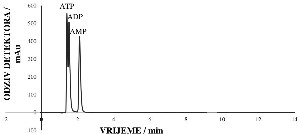
**Slika 12.** Uvećani kromatogram smjese standarda od 0 do 14 min u kojem koncentracije ATP, ADP i AMP iznose  $1000 \mu\text{M}$ . Adenozin-fosfati razdvojeni su gradijentnom metodom prema izvoru Coolen i sur. (2008). Vrijeme zadržavanja molekule ATP iznosilo je 1,41 min, ADP 1,53 min, a AMP 2,11 min.
