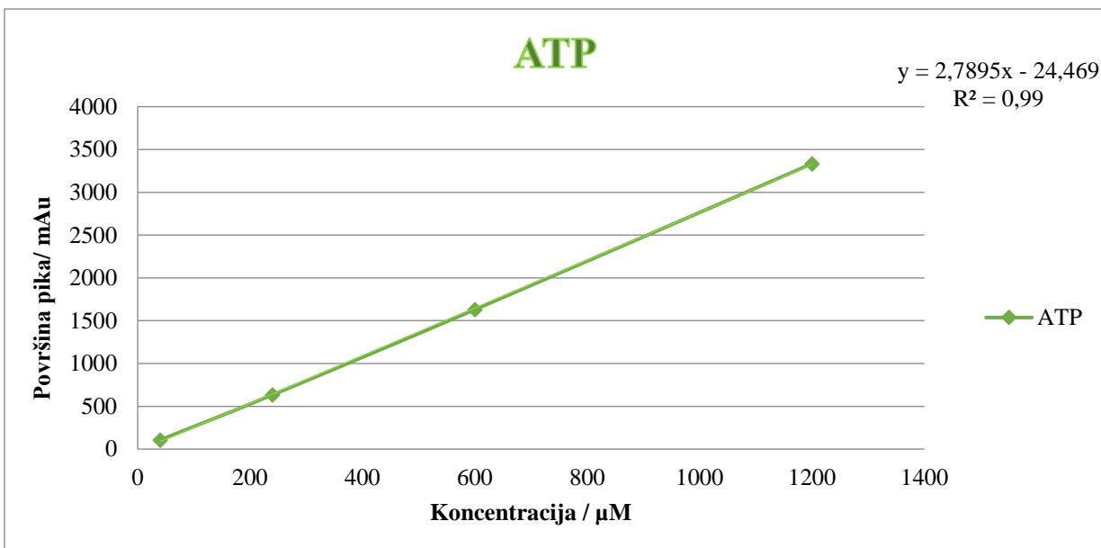
**Slika 15.** Baždarni pravac ovisnosti srednje vrijednosti površine pika o koncentraciji standardne otopine ATP u koncentraciji od 1200, 600, 240 i 40  $\mu\text{M}$ . Svaka od navedenih koncentracija je analizirana u triplikatu s izračunatim % RSD  $\leq 1$ .
