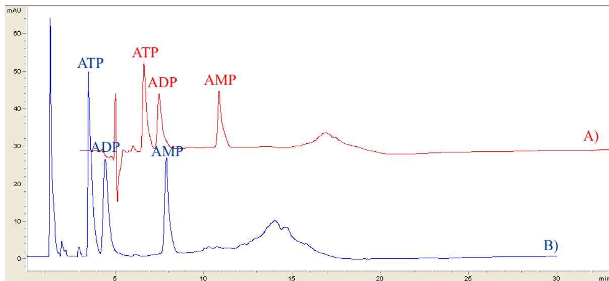
**Slika 24.** Prekloppljeni kromatogrami uzorka ljudske kapilarne krvi prikazani na Slici 22 i 23, nakon pročišćavanja adenozin-fosfata metodom  $\mu$ -SPE uz primjenu aktivnog ugljena kao nepokretne faze (A) i prije pročišćavanja adenozin-fosfata metodom  $\mu$ -SPE uz primjenu aktivnog ugljena kao nepokretne faze (B).
