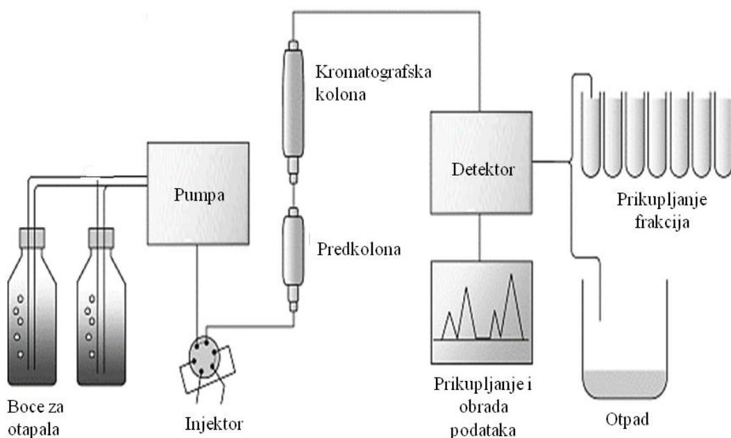
**Slika 10.** Shematski prikaz komponenti tipičnog sustava HPLC.
