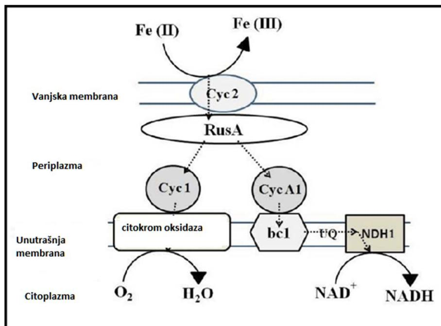
Slika 4.<sup>12</sup> Model za transport elektrona tijekom  $\text{FeS}_2$  oksidacije *A. ferrooxidansa* uključujući početni korak, a to je neizravno otapanje minerala koordiniranim ionima  $\text{Fe}^{3+}$ , a izmijenjeni model uključuje kao početni korak izravni prijenos elektrona iz  $\text{FeS}_2$  u aporusticijanin (RusA) i naknadni prijenos na citokrom c1 ili citokrom A1.
