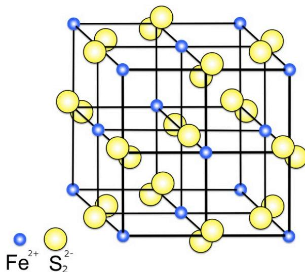
Slika 1. Kristalna struktura prita, ioni Fe<sup>2+</sup> i S<sub>2</sub><sup>2-</sup> tvore strukturu sličnu NaCl. Slika je preuzeta iz literaturnog navoda 5.
