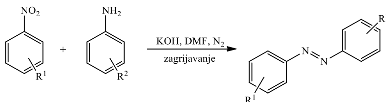
Slika 18. Reakcija supstituiranih anilina i supstituiranih nitrobenzena
