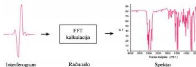
Slika 7. Shematski prikaz dobivanja odgovarajućeg spektra korištenjem Fourierove transformacije 58
