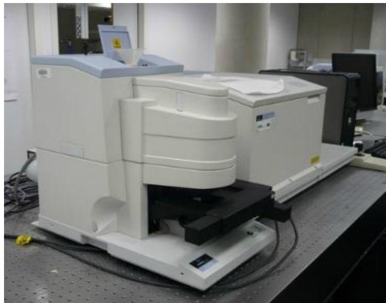
**Slika 14.** FT-IR spektrometar Perkin Elmer GX.
