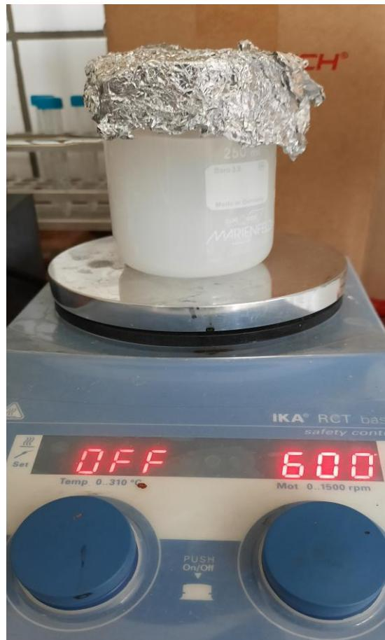
**Slika 10.** Fotografija aparature tijekom sinteze SiO<sub>2</sub> sfera standardnim Stöberovim procesom
