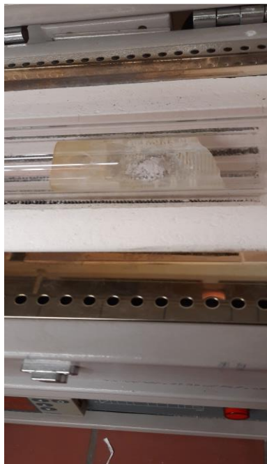
Slika 11. Fotografija aparature tijekom žarenja smjese \text{SiO}_2 sfera i Mg u omjeru 1:1 u lađici za žarenje.
