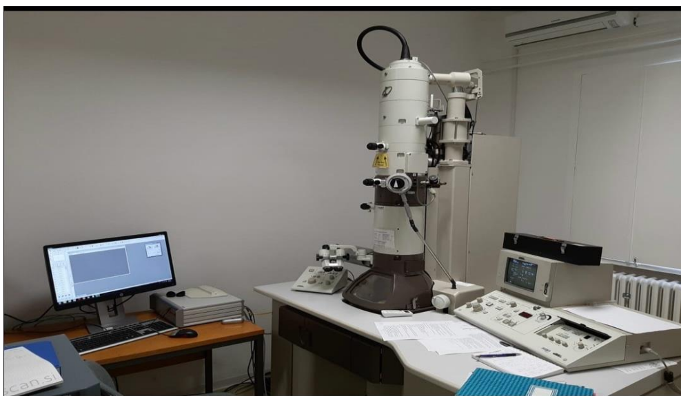
Slika 12. Transmisijski elektronski mikroskop (Joel JEM 1010) povezan s računalom.
