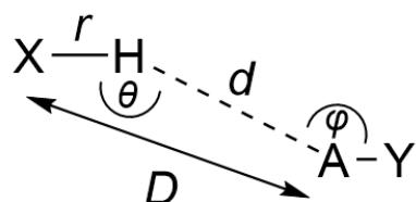
Slika 1. Shematski prikaz vodikove veze i parametri vodikove veze.
