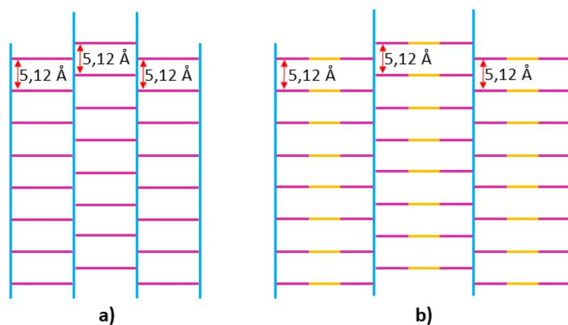
**Slika 12.** Shematski prikaz ljestava koji čini a) jednokomponentni sustav poput  $\gamma$ -kinola ili 4-hidroksibenzojeve kiseline b) kokristal 4-hidroksibenzamida i karboksilne dikiseline. Plava boja označava sinton O-H…O-H, roza boja označava aromatske prstenove, a narančasta boja označava alifatsku karboksilnu dikiselinu. Preuzeto i preuređeno s ref. 40.
