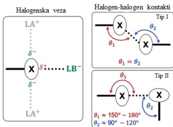
**Slika 2.** Shematski prikaz halogenske veze i tipovi halogen-halogen interakcija. LB<sup>−</sup> je Lewisova baza, a LA<sup>+</sup> Lewisova kiselina. Preuzeto i preuređeno s ref. 18
