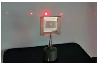
Slika 1.5: Slika dobivena uz pomoć optičke rešetke [6]
