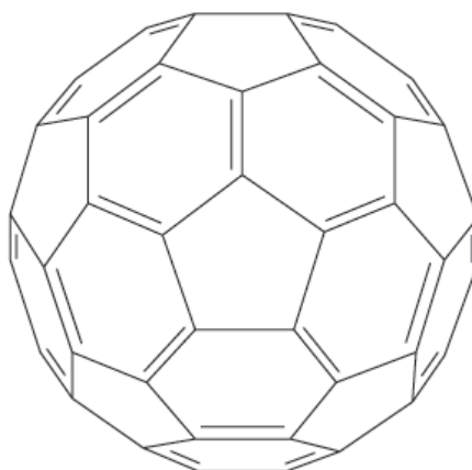
Slika 6: Prikaz lokaliziranih jednostrukih i dvostrukih C-C veza u C 60 4
