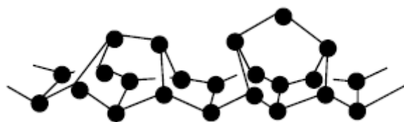
Slika 15: Prikaz strukture Hittorf-ovog fosfor 13
