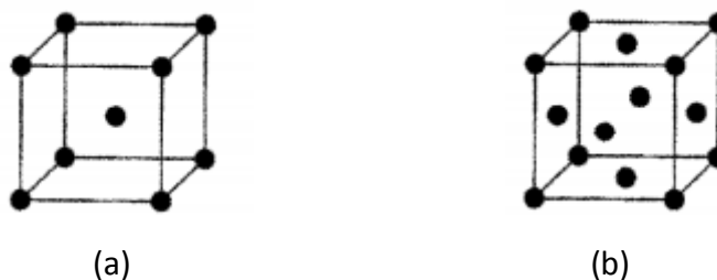
Slika 24: Prikaz prostorno centrirane (a) i plošno centrirane kubične rešetke (b) 22
