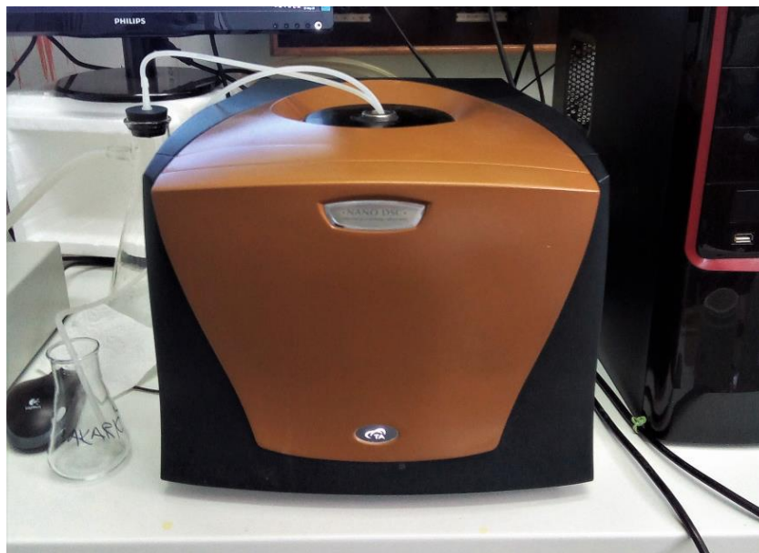
Slika 12. Mikrokalorimetar Nano-DSC, TA Instruments, New Castle, USA (fotografirano u Laboratoriju za biomolekularne interakcije i spektroskopiju Zavoda za organsku kemiju i biokemiju IRB-a)
