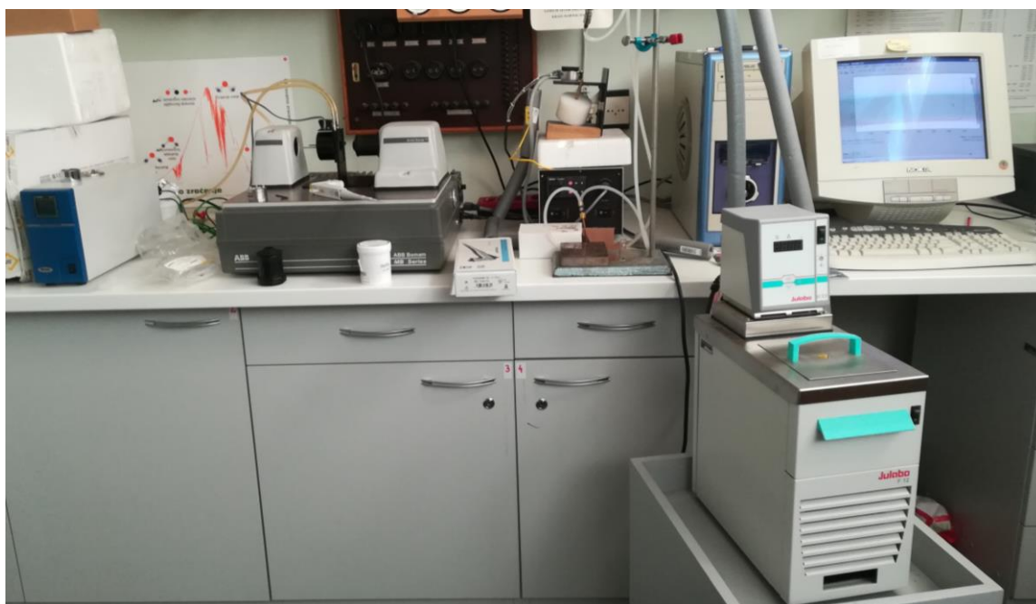
Slika 11. Korišteni IR spektrometar ABB Bomem MB102 i visokotemperaturni grijač Specac 3000 Series (fotografirano u Laboratoriju za biomolekularne interakcije i spektroskopiju Zavoda za organsku kemiju i biokemiju IRB-a)
