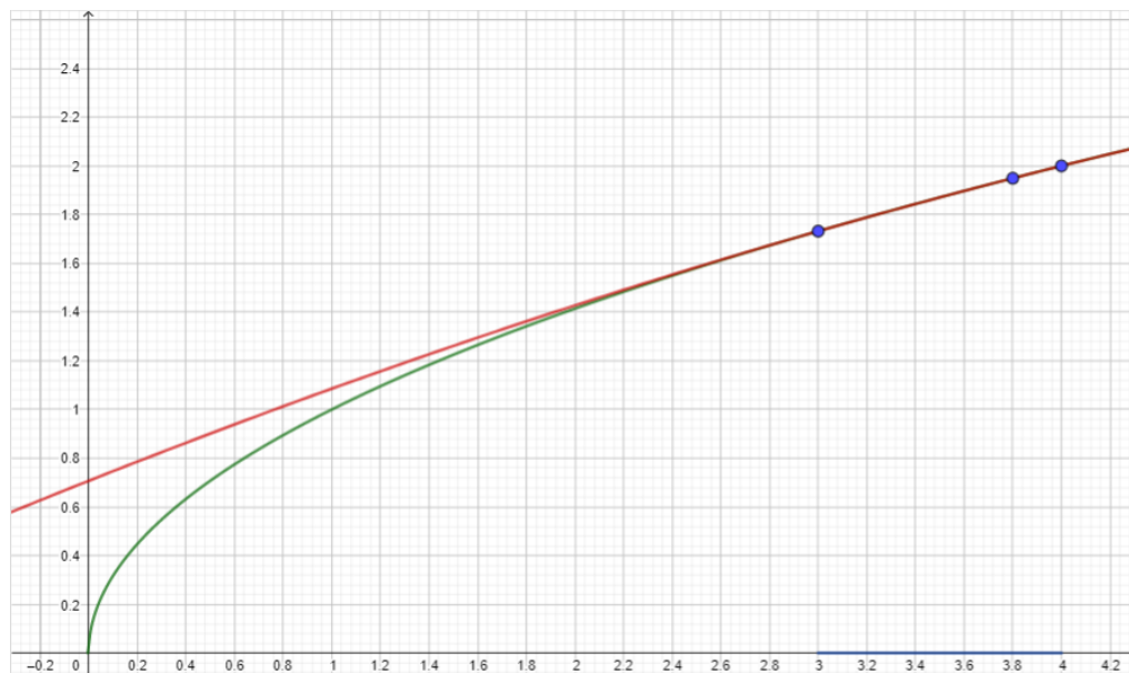
Slika 2.7: Crveno: Newtonov interpolacijski polinom p_2(x) ; zeleno: f(x) = \sqrt{x}
