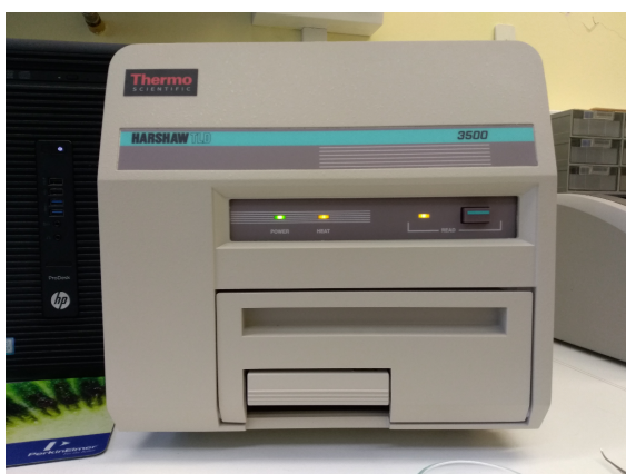
Slika 2.2. Čitač termoluminiscentnih dozimetara TLD 3500 proizvođača Harshaw Chemicals .
