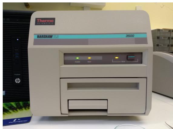
Slika 2.2. Čitač termoluminiscentnih dozimetara *TLD 3500* proizvođača *Harshaw Chemicals*.
