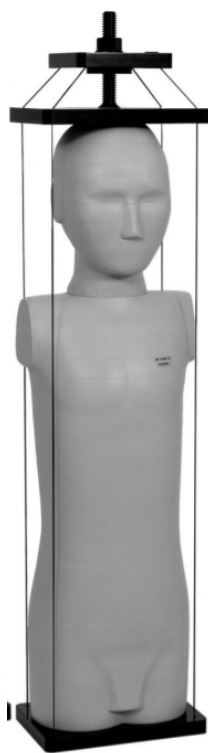
Slika 2.6. Antropomorfni fantom desetogodišnjeg djeteta ATOM proizvođača CIRS . (Izvor: [1])
