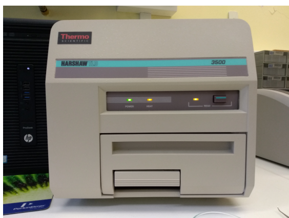
Slika 2.2. Čitač termoluminiscentnih dozimetara TLD 3500 proizvođača Harshaw Chemicals .
