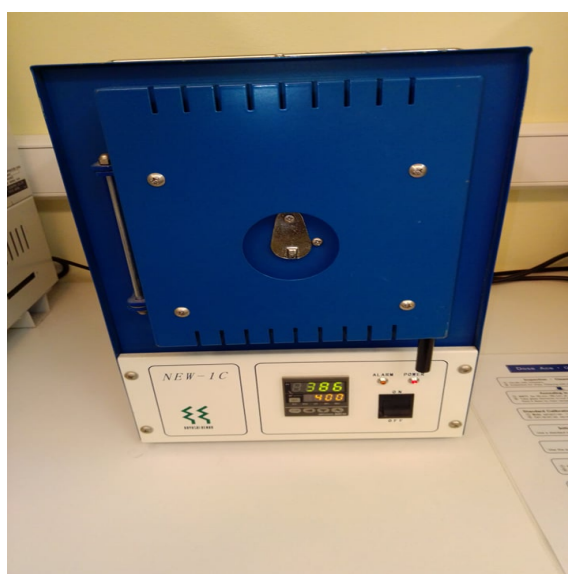
Slika 3.8: Peć za aniliranje dozimetara.
