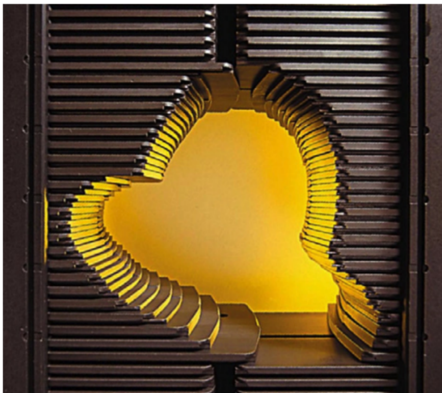
Slika 2.6: Kolimator s više listića napravljen od volframa. Slika je preuzeta iz [4].
