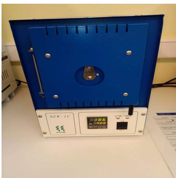
Slika 3.8: Peć za aniliranje dozimetara.
