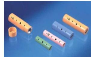
Slika 3.6: Plastični držači. U radu su korišteni plastični držači s filterom za kompenzaciju energijske ovisnosti (žuti).
