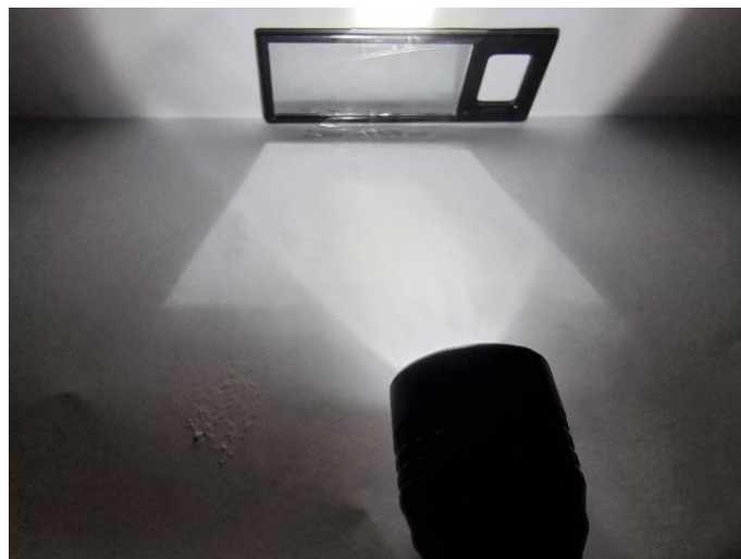
Slika 7. Zrake svjetlosti padaju okomito na zrcalo
