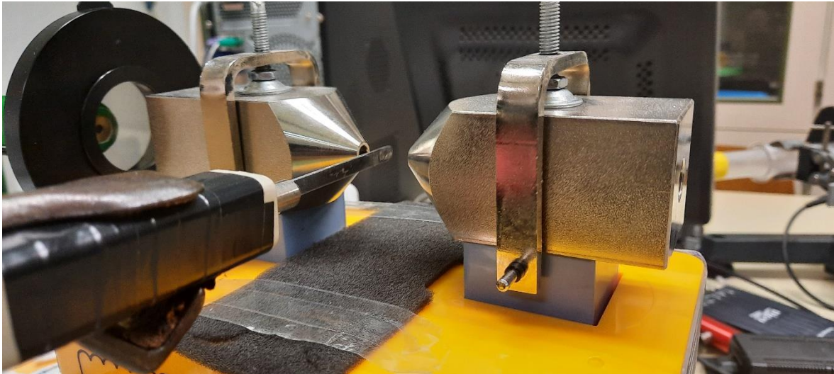
Slika 9. Hallova sonda između magneta. Vrh Hallove sonde nalazi se na pravcu koji spaja rupe elektro-magneta te se svako mjerenje pomiče od lijeva ka desno za zadanu udaljenost. Udaljenost i broj točaka ovisi o uzorku za koji se mjeri magnetsko polje.
