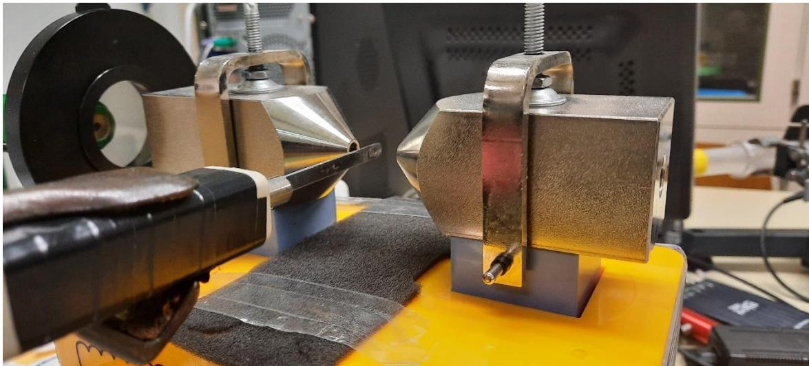
**Slika 9.** Hallova sonda između magneta. Vrh Hallove sonde nalazi se na pravcu koji spaja rupe elektro-magneta te se svako mjerjenje pomiče od lijeva ka desno za zadalu udaljenost. Udaljenost i broj točaka ovisi o uzorku za koji se mjeri magnetsko polje.
