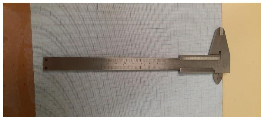
**Slika 19.** Pomično mjerilo s preciznošću 0.1 mm.
