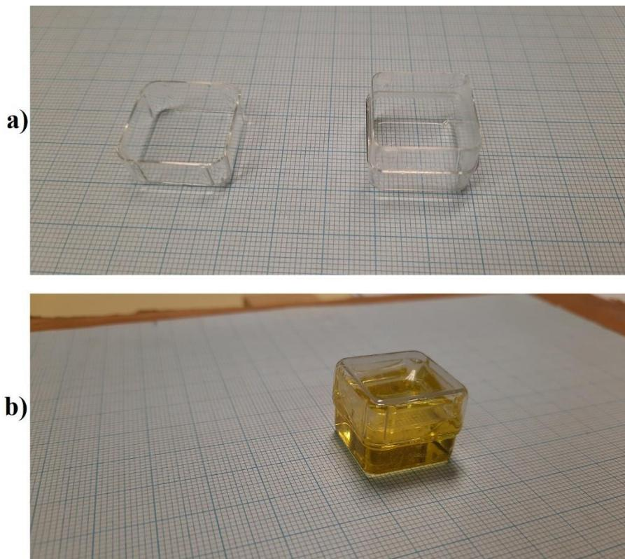
**Slika 22.** (a) Plastična posudica dimenzija:  $x = 20.6 \text{ mm}$ ,  $y = 20.6 \text{ mm}$ ,  $z = 16.8 \text{ mm}$ . Rub posudice kroz koji prolazi svjetlost debljine je  $0.6 \text{ mm}$ , stoga je ukupna dužina uzorka kroz koju prolazi svjetlost  $19.4 \text{ mm}$ . (b) Plastična posudica s maslinovim uljem.
