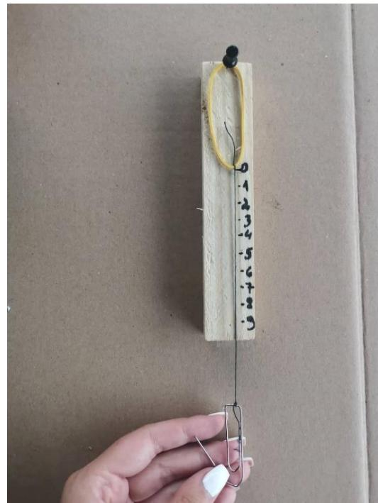
Slika 10. Dinamometar
