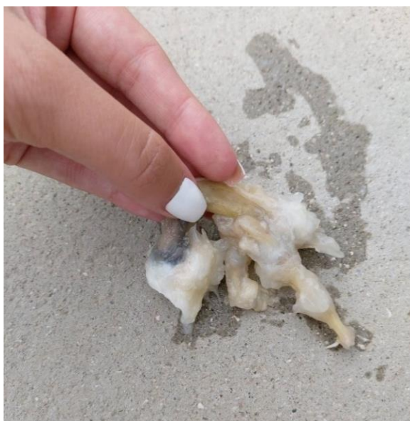
Slika 20. Savitljiva noga nakon dvotjednog stajanja u octu
