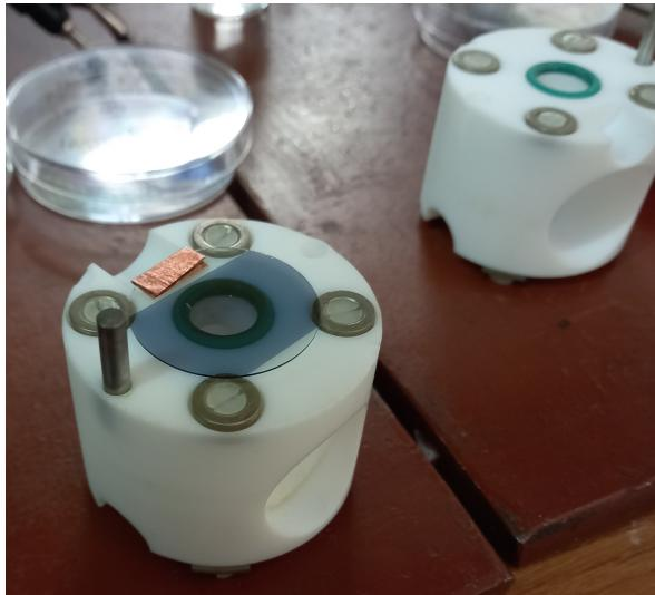
Slika 3.16: Pozicioniranje foto-kondenzatora u elektrokemijskoj ćeliji
