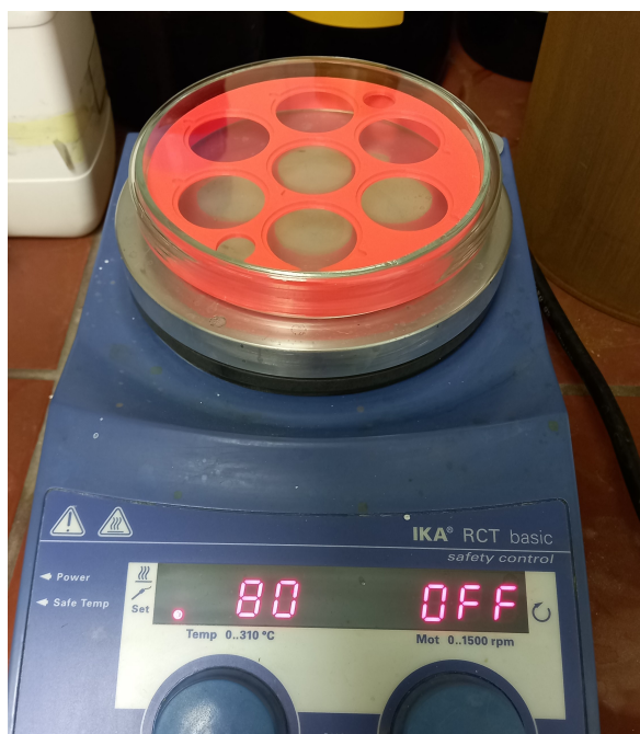
Slika 3.13: Proces silanizacije okruglih stakalca
