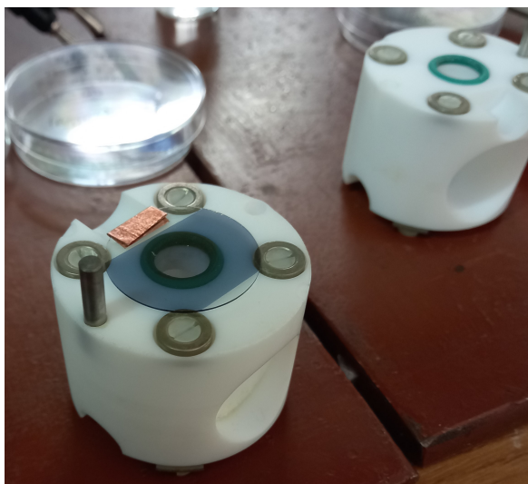
Slika 3.16: Pozicioniranje foto-kondenzatora u elektrokemijskoj ćeliji
