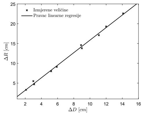
Slika 4.14: Graf promjene radijusa sekundarne dugе etanola u ovisnosti o promjeni udaljenosti tikvice od zastora.
