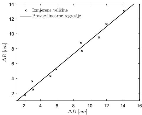
Slika 4.13: Graf promjene radijusa primarne dugе etanola u ovisnosti o promjeni udaljenosti tikvice od zastora.
