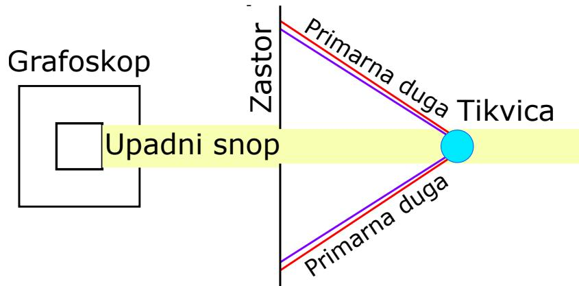
Slika 3.4: Shema eksperimentalnog postava.
