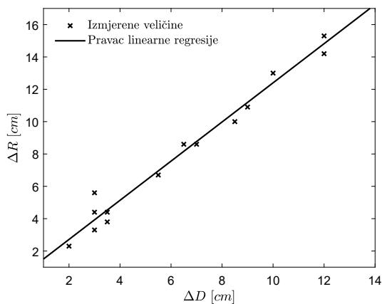
Slika 4.4: Graf promjene radijusa sekundarne dugе vode u ovisnosti o promjeni udaljenosti tikvice od zastora.
