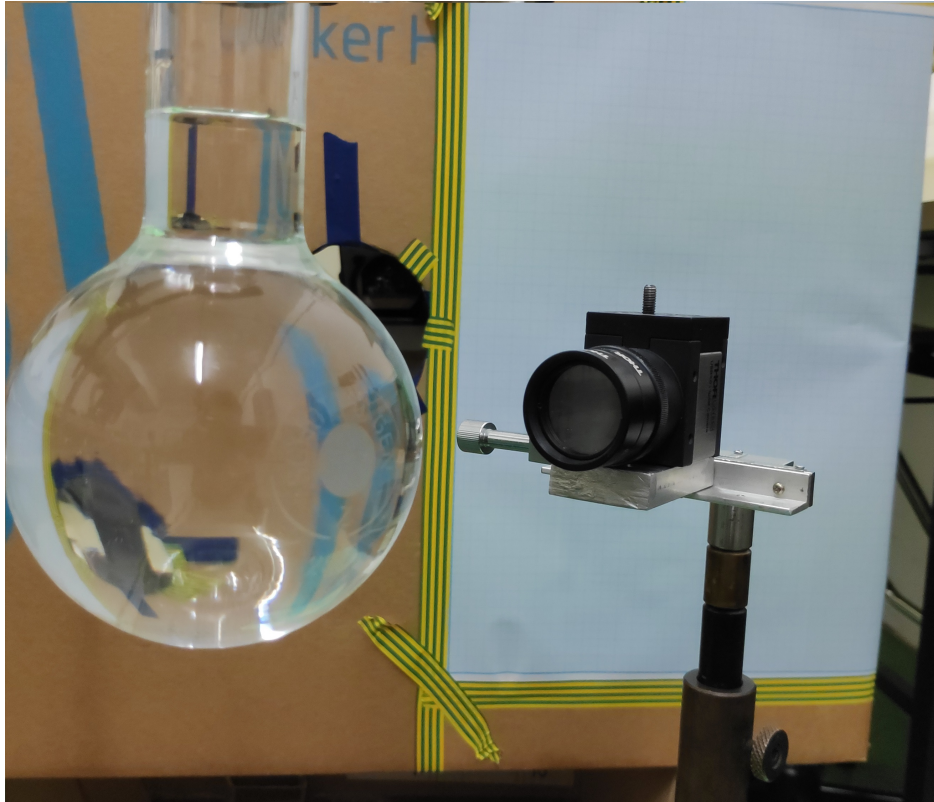
Slika 3.8: Postav za mjerenje širine duge kamerom.
