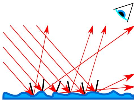
Raspršenje svjetlosti na neravnoj površini.
