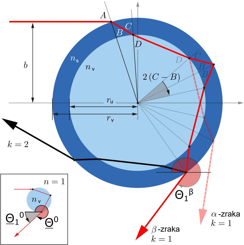
Slika 3.9: Geometrija loma svjetlosti na stijenkama tikvice vanjskog radijusa  $r_v$  i unutrašnjeg radijusa  $r_u$ . Indeksi lomova stijenke tikvice, vode i zraka su  $n_s$ ,  $n_v$  i  $n_z = 1$ . Umetak (lijevo dolje) pokazuje slučaj “gole” sferne kapi vode.  $\beta$ -zraka odgovara Kartezijevoj zraki za  $k = 1$ . Preuzeto iz [5].
