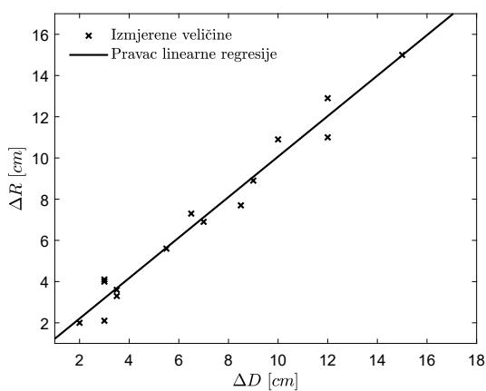
Slika 4.3: Graf promjene radijusa primarne dugе vode u ovisnosti o promjeni udaljenosti tikvice od zastora.
