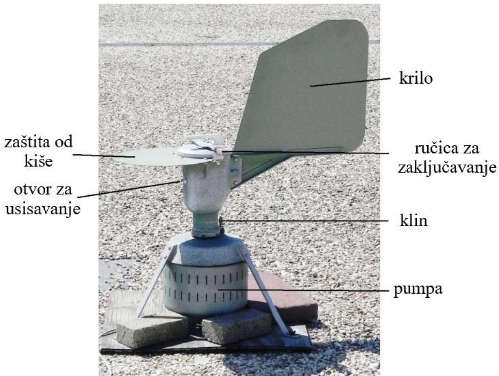
Slika 15. Glavni dijelovi volumetrijskog uređaja tipa Hirst
