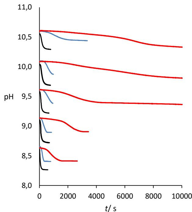
Slika 12. Spontano taloženje kalcijeva karbonata u sustavima pri različitim početnim pH vrijednostima uz dodatak  $c(\text{pAsp}) = 5 \text{ ppm}$  i magnezija ( $c(\text{Ca}):c(\text{Mg}) = 5:1$ ) .
