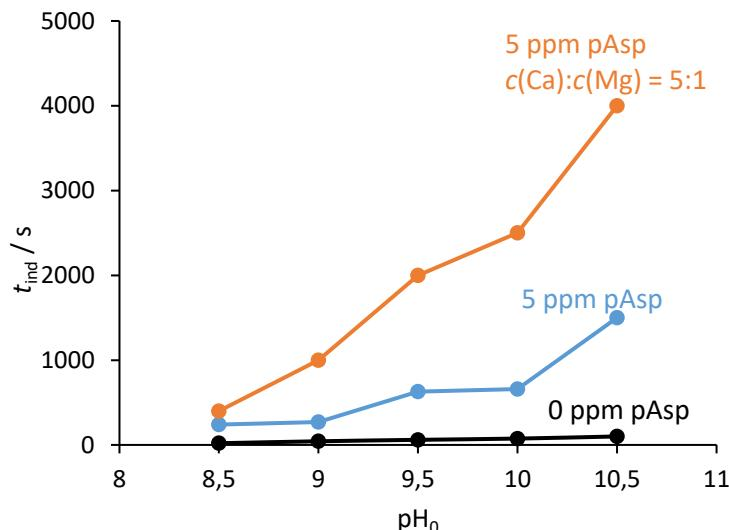
Slika 13. Indukcijsko vrijeme iz pokusa spontanih taloženja kalcijeva karbonata pri različitim početnim pH vrijednostima u sustavima bez pAsp, uz dodatak  $c(pAsp) = 5 \text{ ppm}$  te uz dodatak  $c(pAsp) = 5 \text{ ppm}$  i magnezija ( $c(\text{Ca}):c(\text{Mg}) = 5:1$ ).
