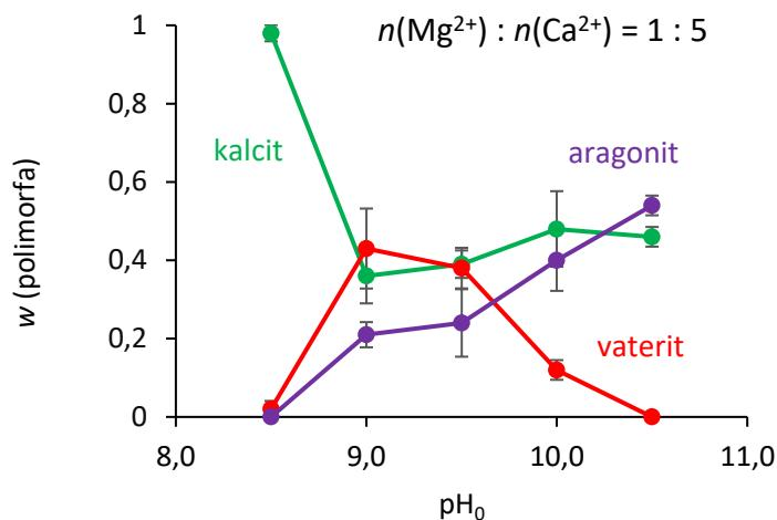
Slika D2. Spontano taloženje kalcijeva karbonata u sustavu uz dodatak magnezija ( $c(\text{Ca}):c(\text{Mg}) = 5:1$ ) pri različitim početnim pH vrijednostima (rezultati iz Diplomskog rada Marka Andrašića u pripremi).
