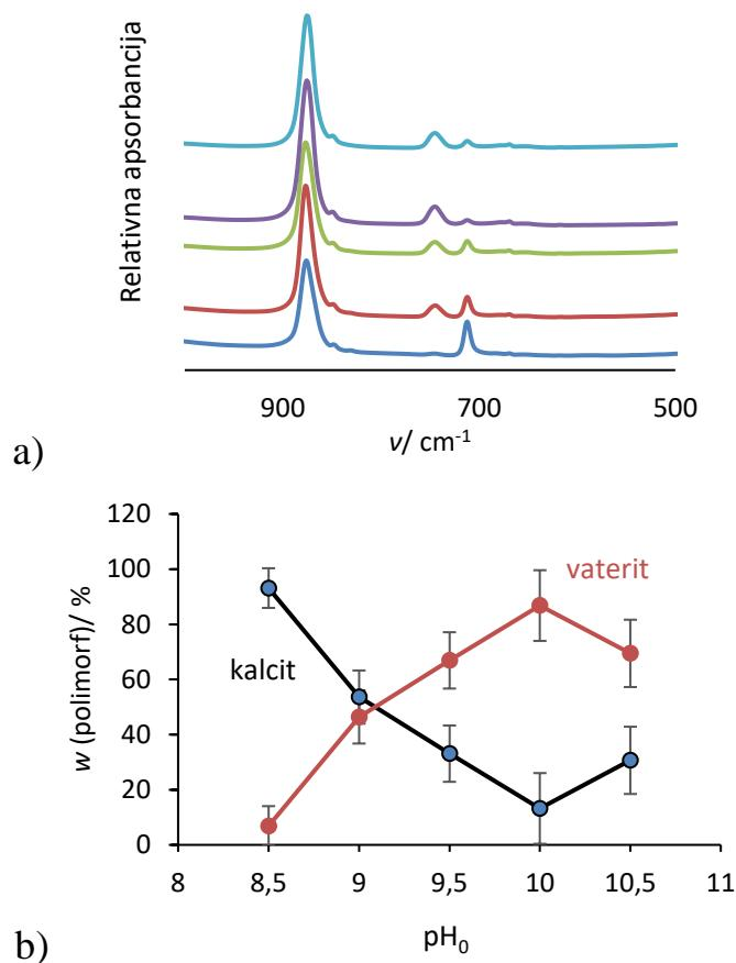
Slika 7. FT-IR spektri taloga (a) i maseni udio polimorfa (b) u talogu iz pokusa spontanih istaloženja kalcijeva karbonata u modelnim sustavima pri različitim početnim pH vrijednostima (pričuvane srednje vrijednosti i pripadajuća odstupanja za tri ponavljanja pri svakom pH<sub>0</sub>).
