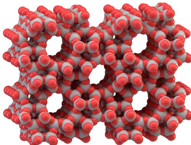
Slika M5. Kalotni model dijela strukture zeolita.<sup>14</sup>
