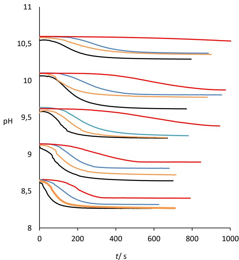
Slika 9. Spontano taloženje kalcijeva karbonata pri različitim početnim pH vrijednostima u sustavima uz dodatak  $c(p\text{Asp})$ : -- 0 ppm, - - 1 ppm, - - - 2 ppm, - - - - 5 ppm.
