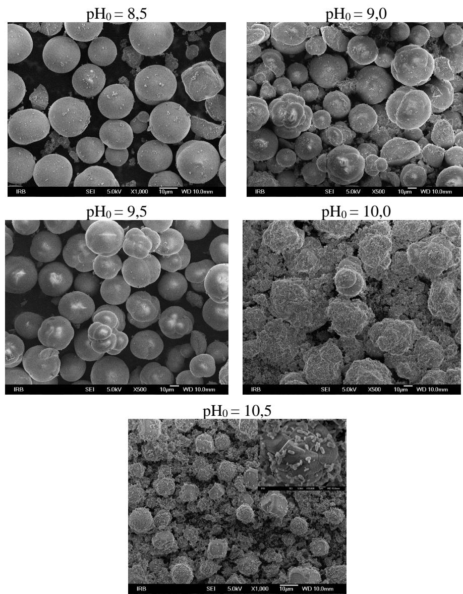
Slika 15. SEM snimke taloga iz pokusa spontanih taloženja kalcijeva karbonata pri različitim početnim pH vrijednostima u sustavima uz dodatak  $c(\text{pAsp}) = 5 \text{ ppm}$  i magnezija ( $c(\text{Ca}):c(\text{Mg}) = 5:1$ ).
