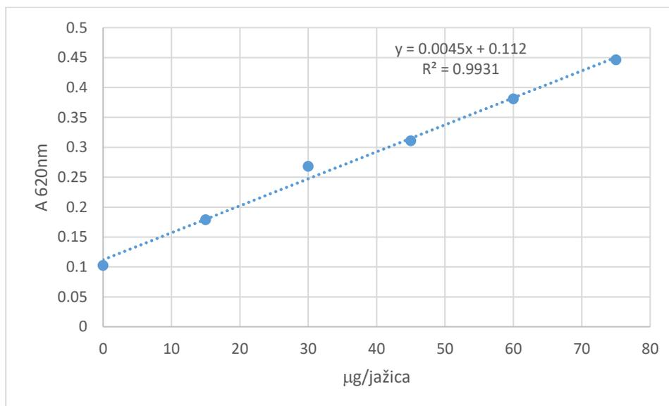
**Slika 4.** Kalibracijska krivulja standarda albumina mase od 0 do 75 µg po jažici mjerenih na 620 nm.
