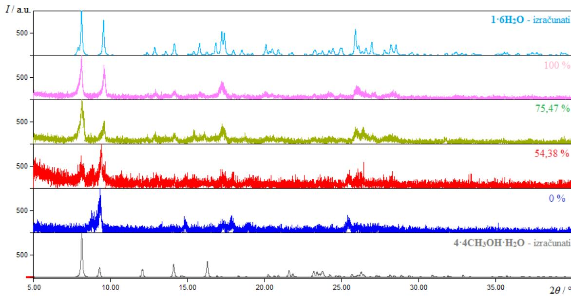
Slika 25. Usporedba difraktograma praha spoja  $4 \cdot 4\text{CH}_3\text{OH} \cdot \text{H}_2\text{O}$  pri sobnoj temperaturi i različitim relativnim vlažnostima zraka (100 %, 75,47 %, 54,38 % i 0 %) s difraktogramom izračunatim iz kristalne strukture spoja  $1 \cdot 6\text{H}_2\text{O}$  dobivene pri temperaturi 170 K
