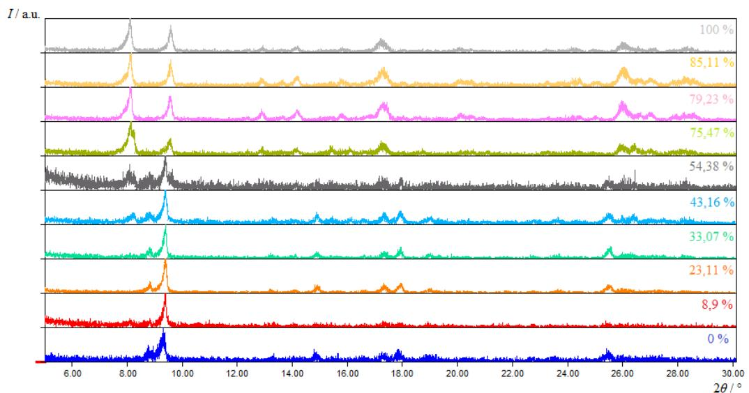
Slika D25. Difraktogrami praha kristala spoja  $4 \cdot 4\text{CH}_3\text{OH} \cdot \text{H}_2\text{O}$  pri različitim relativnim vlažnostima zraka (100 %, 85,11 %, 79,23 %, 75,47 %, 64,92 %, 54,38 %, 43,16 %, 33,07 %, 23,11 %, 8,9 % i 0 %) snimljeni nakon 10 dana
