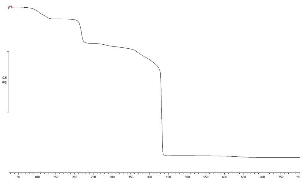
Slika D23. TG krivulja produkta raspada spoja  $\{[\text{Cu}(\mu\text{-Gly})(\text{phen})]_2\text{SO}_4 \cdot 4\text{CH}_3\text{OH} \cdot \text{H}_2\text{O}\}_n$  ( $4 \cdot 4\text{CH}_3\text{OH} \cdot \text{H}_2\text{O}$ ) u suhoj komori ( $RH = 0\%$ )
