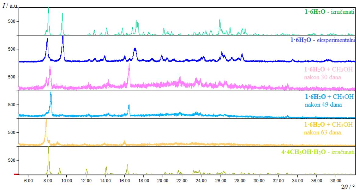
Slika 26. Usporedba difraktograma praha spoja  $\mathbf{1}\cdot\mathbf{6H}_2\mathbf{O}$  prikupljenih tijekom njegove izloženosti parama metanola s eksperimentalnim difraktogramom spoja  $\mathbf{1}\cdot\mathbf{6H}_2\mathbf{O}$  i izračunatim difraktogramima spojeva  $\mathbf{1}\cdot\mathbf{6H}_2\mathbf{O}$  i  $\mathbf{4}\cdot\mathbf{4CH}_3\mathbf{OH}\cdot\mathbf{H}_2\mathbf{O}$ . Izračunati difraktogrami dobiveni su na temelju podataka o kristalnim strukturama na temperaturi 170 K
