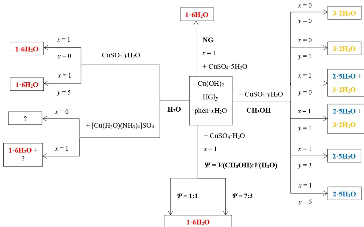
Slika 16. Shematski prikaz mehanokemijskih sintetskih postupaka u kojima su dobiveni sljedeći spojevi:  $[\text{Cu}(\text{Gly})(\text{H}_2\text{O})(\text{phen})]_2\text{SO}_4 \cdot 6\text{H}_2\text{O}$  ( $\mathbf{1\cdot 6H_2O}$ ),
