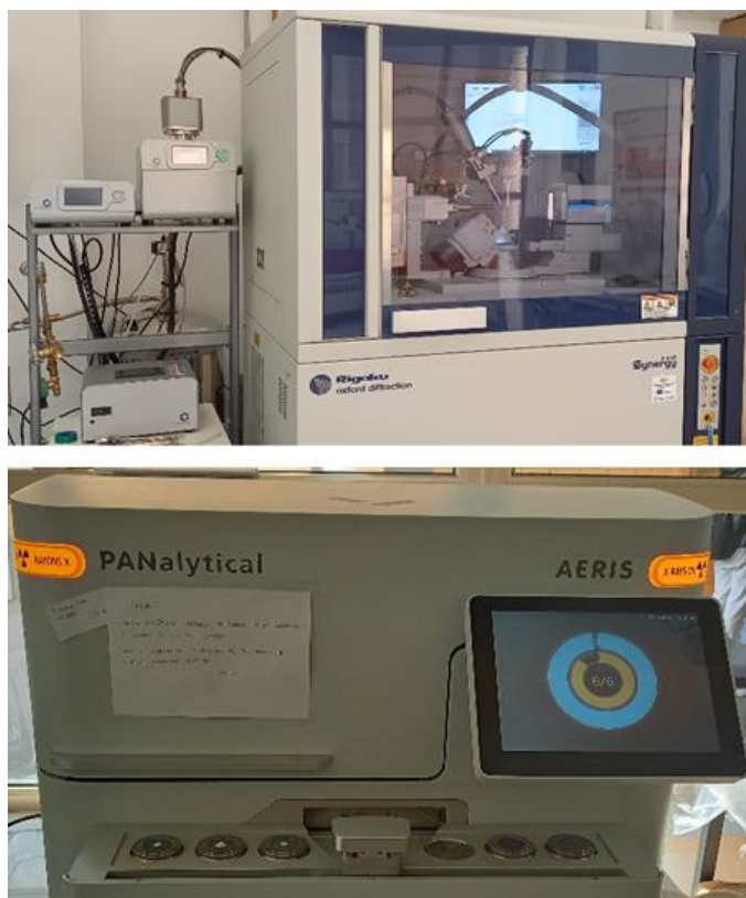
Slika 11. Difraktometar za jedinični kristal (gore) i difraktometar za polikristal (dolje)
