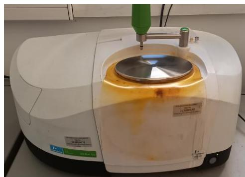
Slika 9. SpectrumTwo FT-IR spektrometar s dijamantnim ATR dodatkom
