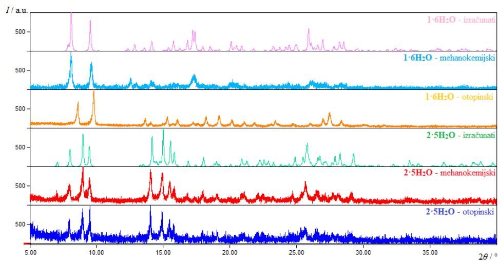
Slika D5. Usporedba eksperimentalno dobivenih difraktograma praha spojeva **1·6H<sub>2</sub>O** i **2·5H<sub>2</sub>O** s izračunatim difraktogramima. Izračunati difraktogrami dobiveni su na temelju podataka o kristalnim strukturama na temperaturi 170 K (**1·6H<sub>2</sub>O**) i 100 K (**2·5H<sub>2</sub>O**)
