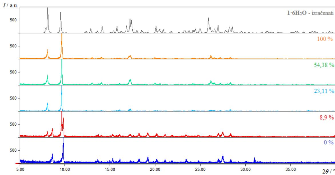
Slika 24. Usporedba difraktograma praha spoja **1·6H<sub>2</sub>O** snimljenih nakon 10 dana pri sobnoj temperaturi i različitim relativnim vlažnostima zraka (100 %, 54,38 %, 23,11 %, 8,9 % i 0%) s difraktogramom izračunatim iz kristalne strukture spoja **1·6H<sub>2</sub>O** dobivene pri temperaturi 170 K
