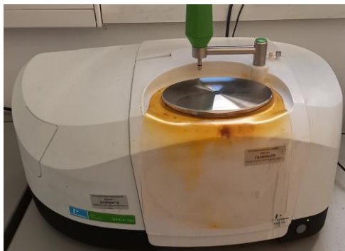
Slika 9. SpectrumTwo FT-IR spektrometar s dijamantnim ATR dodatkom
