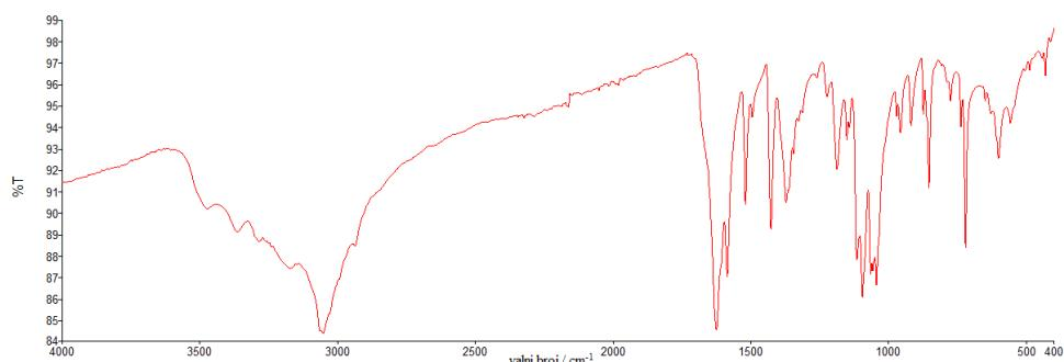
Slika D18. IR spektar produkta raspada spoja  $\{[\text{Cu}(\mu\text{-Gly})(\text{phen})]_2\text{SO}_4 \cdot 4\text{CH}_3\text{OH} \cdot \text{H}_2\text{O}\}_n$  ( $\mathbf{4} \cdot \mathbf{4}\text{CH}_3\text{OH} \cdot \text{H}_2\text{O}$ ) u suhoj komori ( $RH = 0 \%$ )
