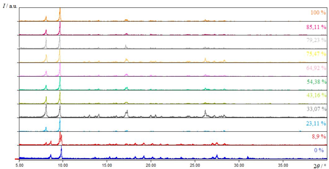
Slika D24. Difraktogrami praha kristala spoja  $1 \cdot 6\text{H}_2\text{O}$  pri različitim relativnim vlažnostima zraka (100 %, 85,11 %, 79,23 %, 75,47 %, 64,92 %, 54,38 %, 43,16 %, 33,07 %, 23,11 %, 8,9 % i 0 %) snimljeni nakon 10 dana
