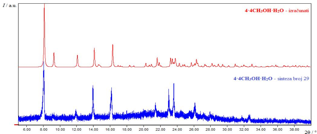
Slika 20. Usporedba izračunatog i eksperimentalno dobivenog difraktograma praha otopinski sintetiziranog spoja  $\{[\text{Cu}(\mu\text{-Gly})(\text{phen})]_2\text{SO}_4 \cdot 4\text{CH}_3\text{OH} \cdot \text{H}_2\text{O}\}_n$  (**4·4CH<sub>3</sub>OH·H<sub>2</sub>O**) (tablica 9, sinteza broj 29). Izračunati difraktogram dobiven je na temelju podataka o kristalnoj strukturi na temperaturi 170 K
