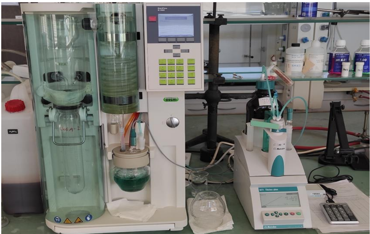
Slika 11. Prikaz destilacijskog aparata koji se sastoji od uređaja za destilaciju (B-324 Kjeldahl «BÜCHI» ; K-360 KjellFlex «BÜCHI») i uređaja za automatsku titraciju (TIP 702SM Titrino; TIP 877 Titrino plus).
