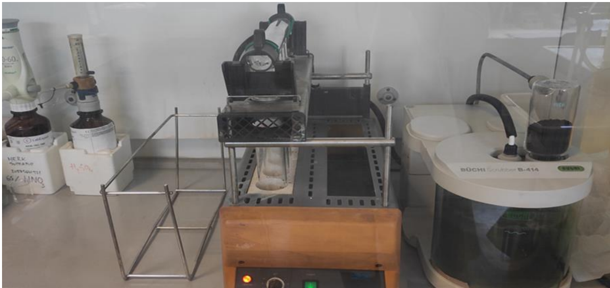
Slika 10. Prikaz bloka za razaranje uzorka koji se sastoji od uređaja za digestiju (TIP K-424 «BÜCHI») i uređaja za ispiranje i neutralizaciju (B-414 (scrubber) «BÜCHI»)
