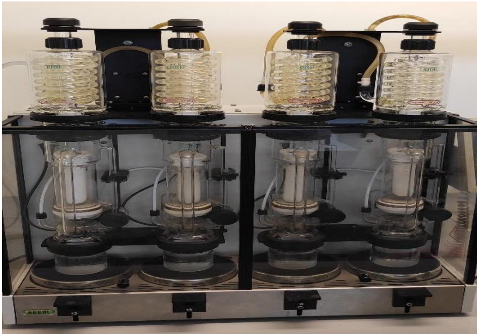
Slika 12. Prikaz ekstrakcijskog aparata koji se sastoji od uređaja za ekstrakciju masti (Buchi B-811 RU 57-200; Soxtec™ RU 59-200) i uređaja za hidrolizu masti (SC 247 SoxCap™ RU 62-200).
