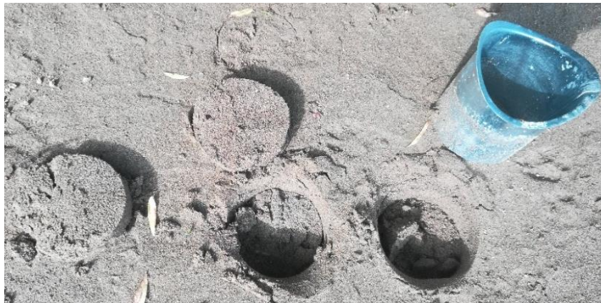
Slika 9. Uzorkovanje sedimenta metalnim cilindrom
