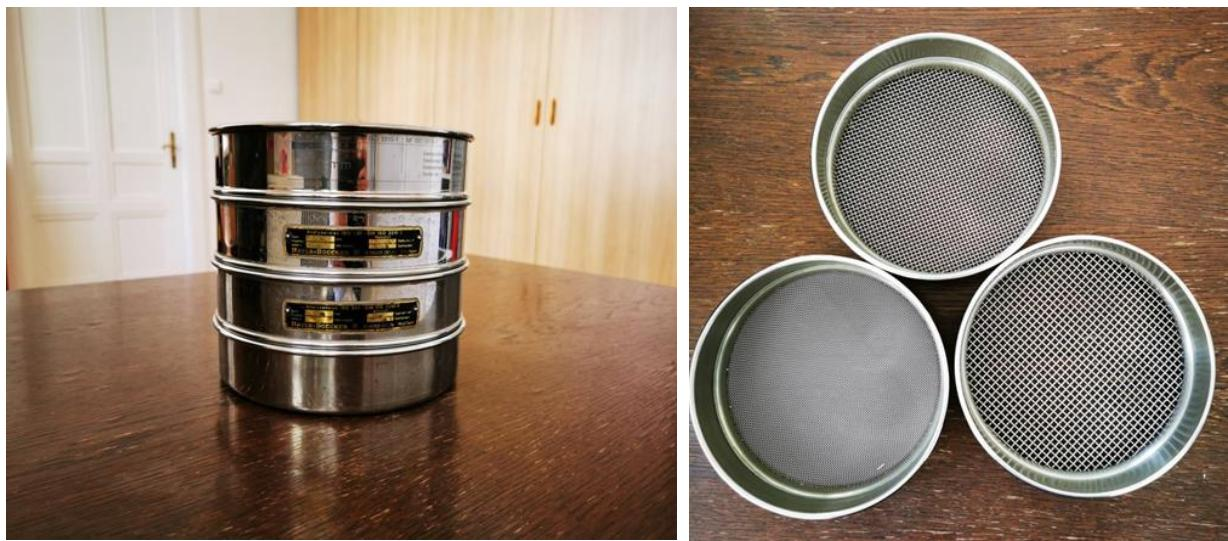
**Slika 4.** Sita za prosijavanje uzorka veličine oka 4, 2,5 i 1,0 mm
