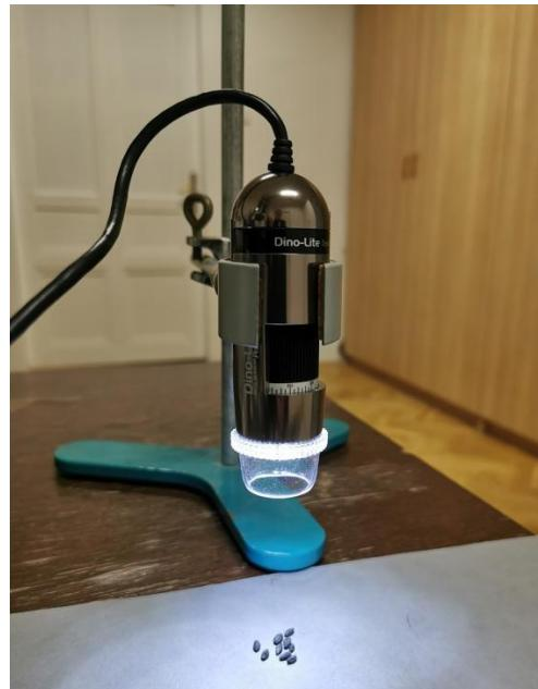
**Slika 6.** Fotografiranje biljnih makrofosila kamerom digitalnog mikroskopa DinoLite
