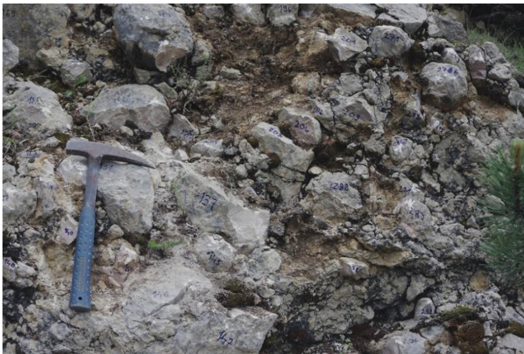
Slika 11. Određivanje litologije i brojanje klasta u fliškoj breči.
