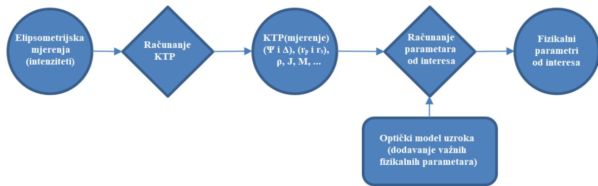
Slika 7. Osnovni koraci računanja podataka dobivenih elipsometrijskim mjerjenjima.
