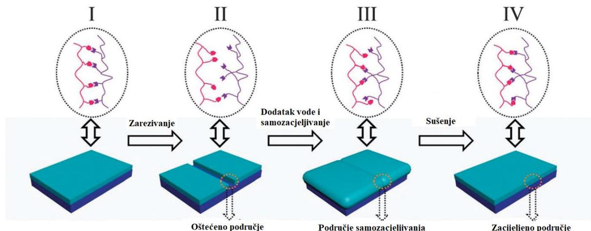
Slika 4. Shematski prikaz samozacjeljivanja CS/PAA polielektrolitnog višesloja (preuzeto i prilagođeno iz Y. Zhu, H. Xuan, J. Ren, L. Ge, *Soft Matter* **11** (2015) 8452–8459.)
