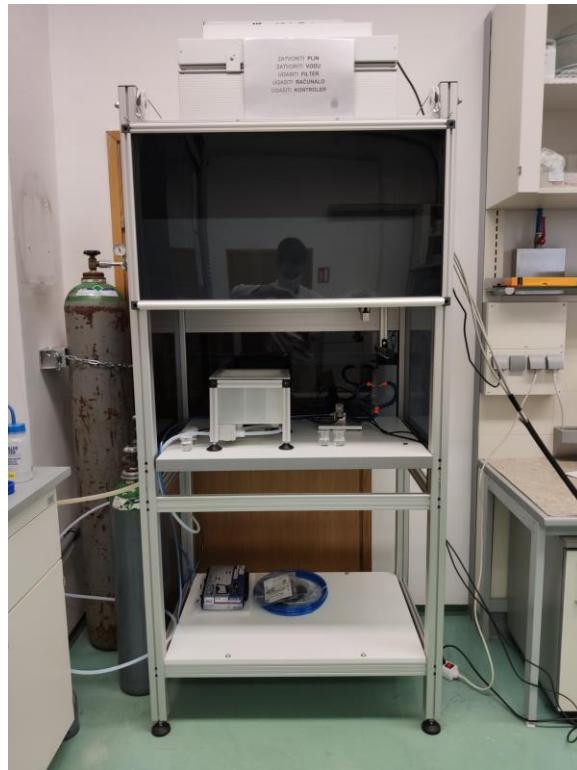
Slika 14. Robot za automatiziranu pripravu polielektrolitnih višeslojeva
