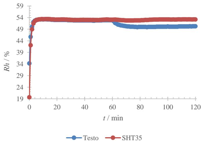
Slika 20. Usporedba ovisnosti relativne vlažnosti iznad zasićene otopine magnezijeva nitrata o vremenu za dva senzora
