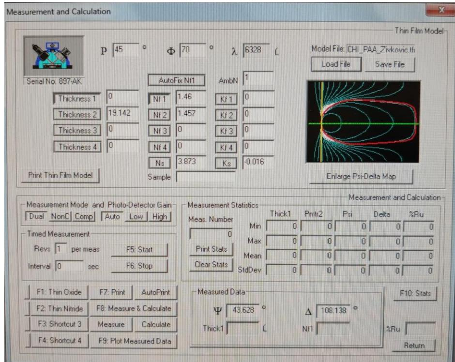
Slika 16. Model četverosloja postavljen u računalnom programu *Gaertner Ellipsometer Measurement Program v. 8.071*
