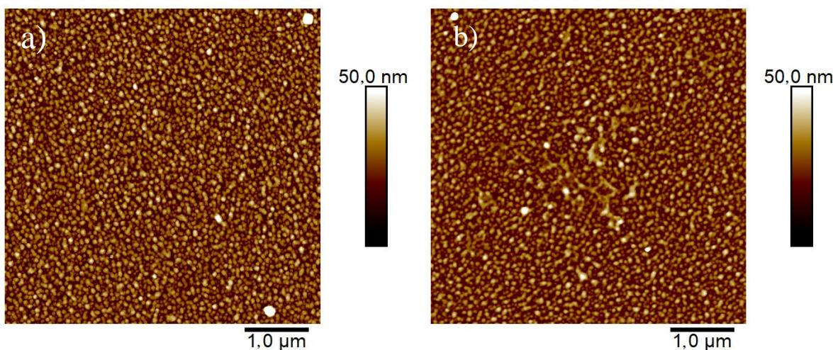
Slika 32. AFM prikazi  $5 \mu\text{m} \times 5 \mu\text{m}$  površine višesloja CS/PAA od 10 slojeva: a) za uzorak prije izlaganja visokoj relativnoj vlažnosti i b) za uzorak nakon izlaganja visokoj relativnoj vlažnosti (99 %) 48 sati
