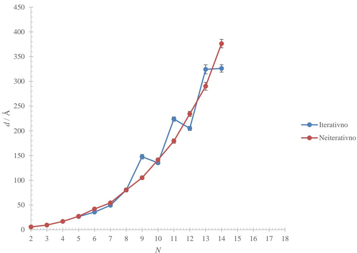
Slika 23. Ovisnosti debljine višesloja CS/PAA o broju adsorbiranih polielektrolitnih slojeva za iterativno i neiterativno elipsometrijsko mjerjenje
