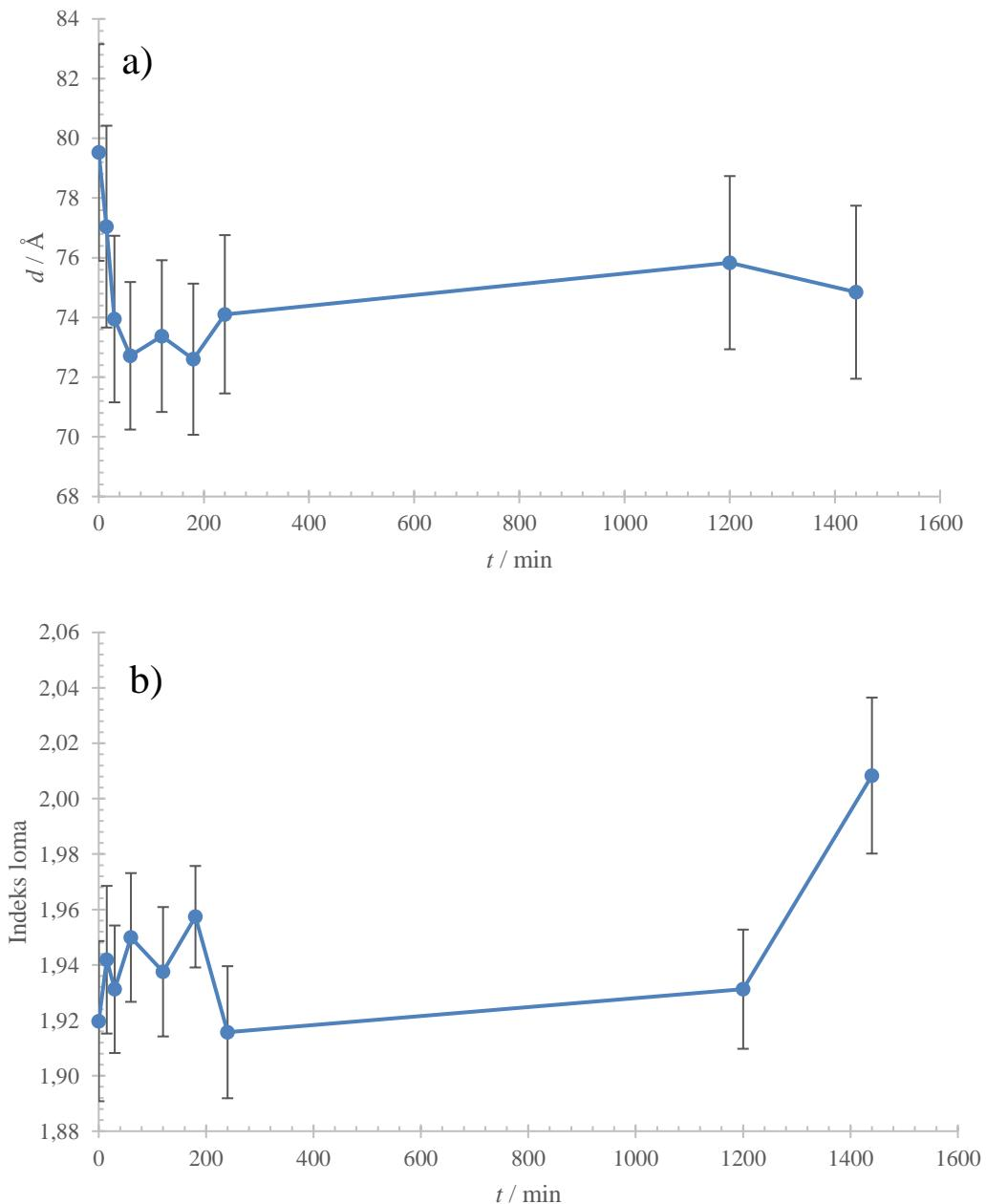
Slika 26. Ovisnost a) debljine i b) indeksa loma filma CS/PAA od 10 slojeva o vremenu provedenom pri 50 % relativne vlažnosti. Uzorak je prethodno proveo 24 h pri visokoj  $Rh (> 99\%)$  te su mjerena provedena iterativno
