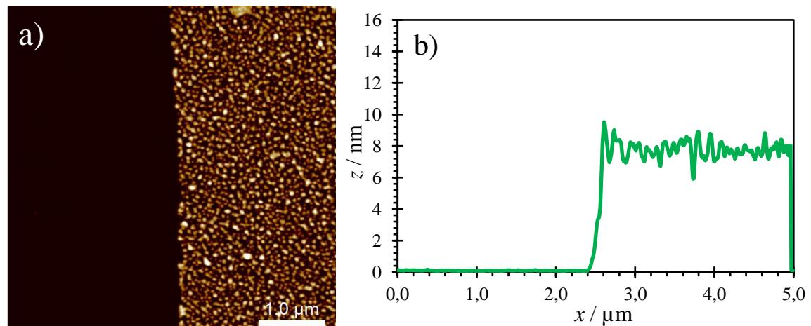
Slika 34. a) AFM prikaz  $5 \mu\text{m} \times 5 \mu\text{m}$  površine višesloja CS/PAA od 10 slojeva i zareza nakon izlaganja visokoj relativnoj vlažnosti 48 sati, b) prosječni visinski profil na zarezu za navedeni uzorak nakon izlaganja visokoj relativnoj vlažnosti 48 sati
