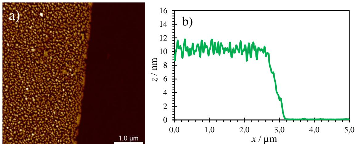
Slika 33. a) AFM prikaz  $5 \mu\text{m} \times 5 \mu\text{m}$  površine višesloja CS/PAA od 10 slojeva i zareza prije izlaganja visokoj relativnoj vlažnosti, b) prosječni visinski profil na zarezu za navedeni uzorak prije izlaganja visokoj relativnoj vlažnosti
