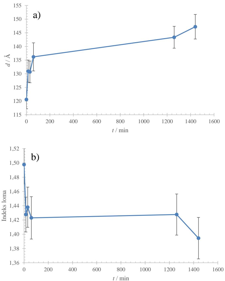
Slika 25. Ovisnost a) debljine i b) indeksa loma filma CS/PAA od 10 slojeva o vremenu provedenom pri  $50\%$  relativne vlažnosti. Uzorak je prethodno proveo  $24\text{ h}$  pri niskoj  $Rh$  ( $< 3\%$ ) te su elipsometrijska mjerena provedena iterativno
