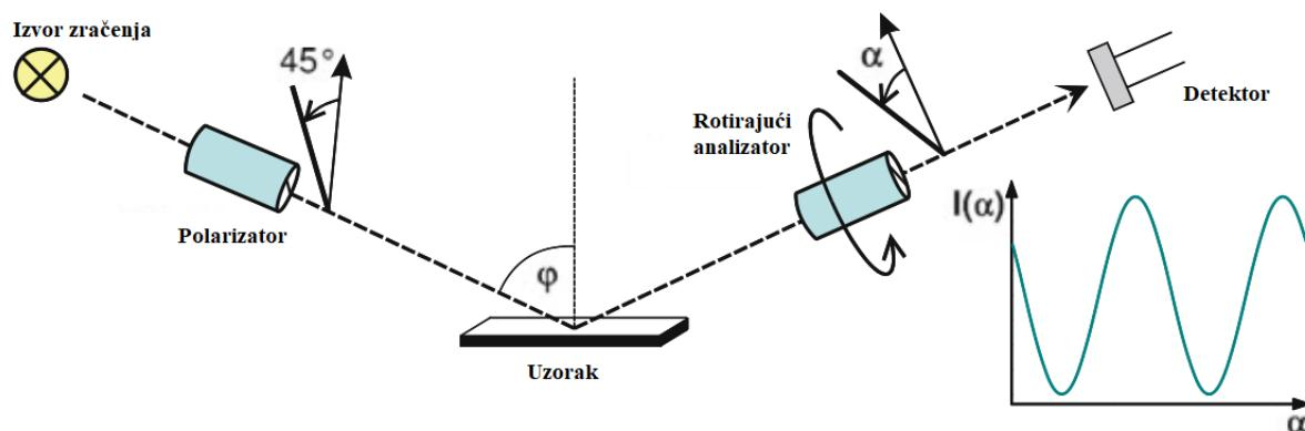
Slika 9. Dijelovi elipsometra s rotirajućim analizatorom i polarizatorom koji ima os transmisije pomaknutu za  $45^\circ$  u odnosu na ravninu upadnog zračenja. Desno je primjer snimljenog signala na detektoru te se vidi ovisnost intenziteta o kutu analizatora (preuzeto i prilagođeno iz C. Cobet, u K. Hinrichs, K.-J. Eichhorn (ur.), *Ellipsometry of Functional Organic Surfaces and Films*, Springer International Publishing, Cham, 2018, 1–27.)
