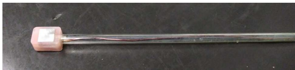
Slika 3.2. Radna elektroda
