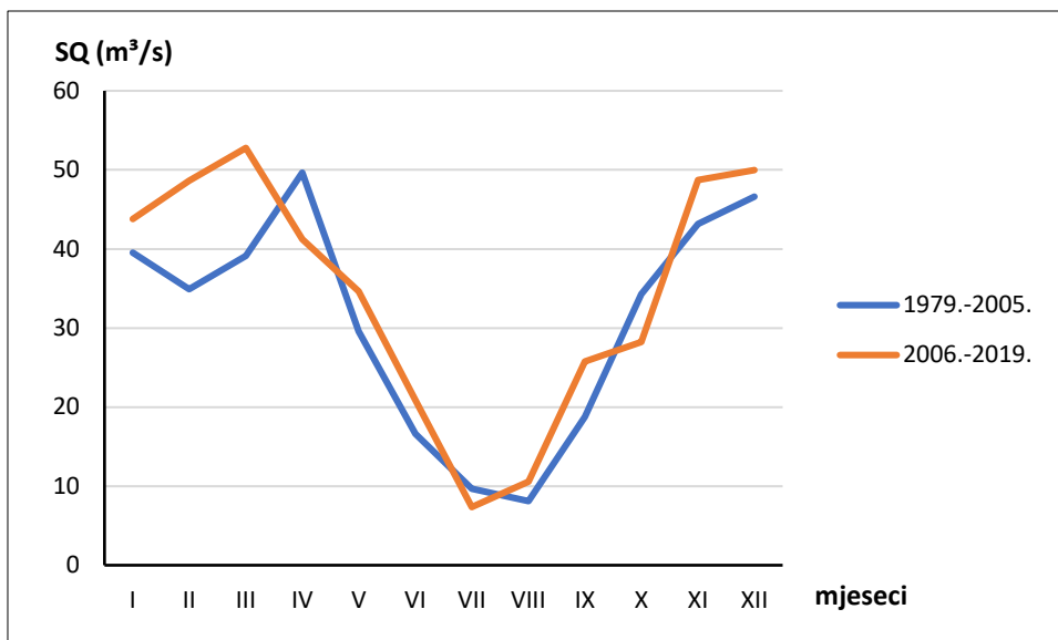
Sl.9. Usporedba prosječnih mjesečnih vrijednosti srednjih protoka na postaji Lešće Toplice u razdoblju 1979.-2005. i 2006.-2019.
