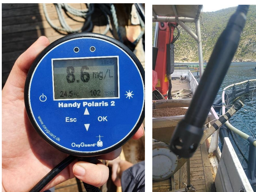
Slika 9. Ručna sonda za mjerenje temperature te koncentracije i postotka zasićenja mora kisikom
