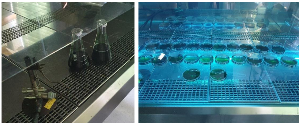
Slika 14. Skuhane TCBS podloge, te izlivenne u Petrijeve zdjelice u kojima se suše pod UV svjetlom
